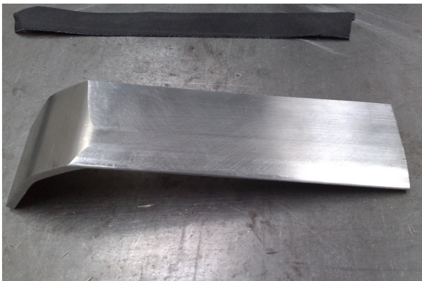
Obrázek 29 Vyprofilovaná nosná noha Hydrofoilu
