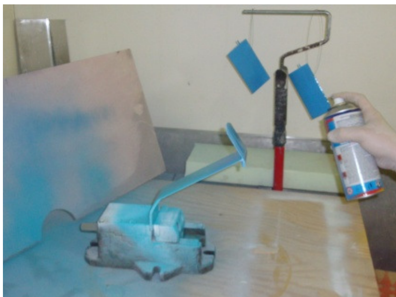
Obrázek 35 Stříkání modelu barvou
