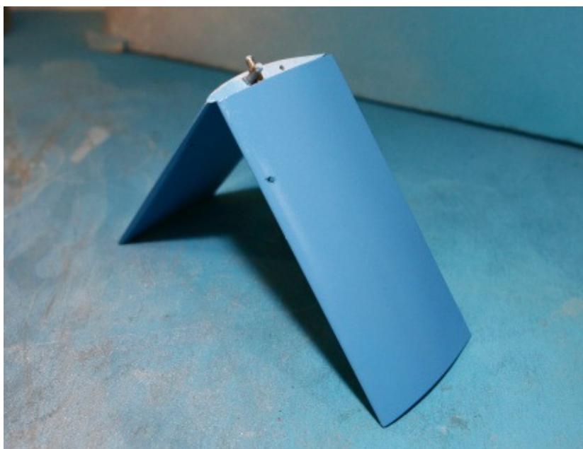
Obrázek 31 Hotová křídla s otvory na pomocné plováčky
