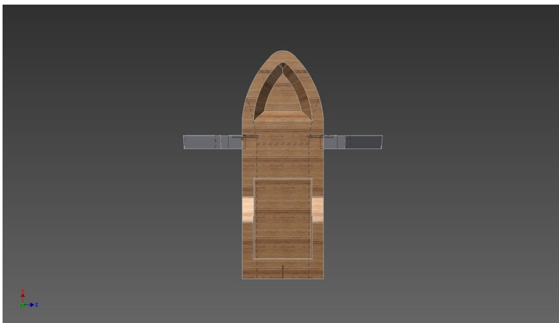
Obrázek 19 umístění nohou na trup pohled shora, autor M. Šereda
