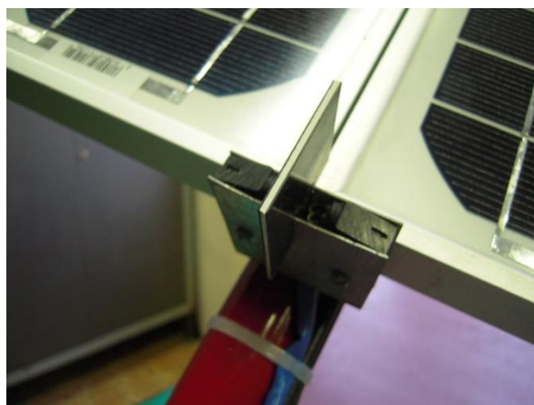
Obr. 7 - Fotorezistory pro snímání Slunce
