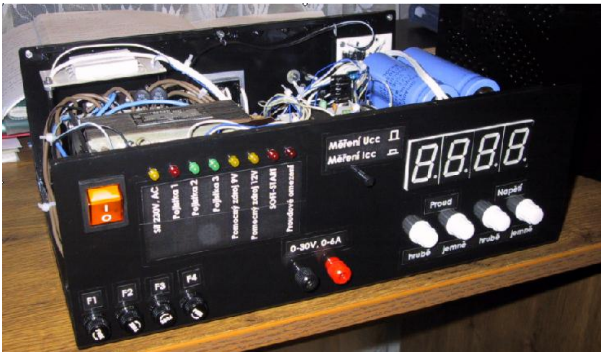
Obr.49 – Dokončený a plně funkční laboratorní zdroj 0-30V, 0-6A
