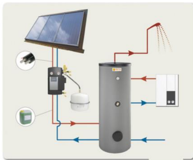
Obr. 6: Schéma montáže solárního zařízení (6,13 m 2 ) Zdroj: www.elk.cz
