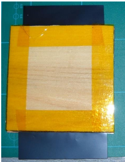
Obrázek 8 Zásahová plocha připravená k připájení hran
