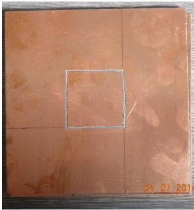
Obrázek 6 Základnová deska se samostatnou středovou částí
