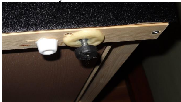
Obrázek 18 Nastavitelné nožičky terče
