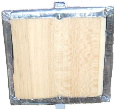
Obrázek 10 Zásahová plocha terče s připájeným kontaktním rámečkem
