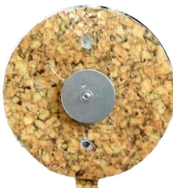
Obrázek 5 Zásahová plocha terče se středovým pohyblivým kontaktem
