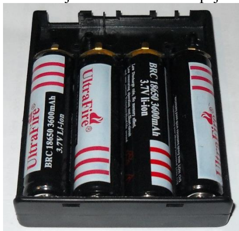
Obrázek 38 Akumulátory Li-Ion v držáku
