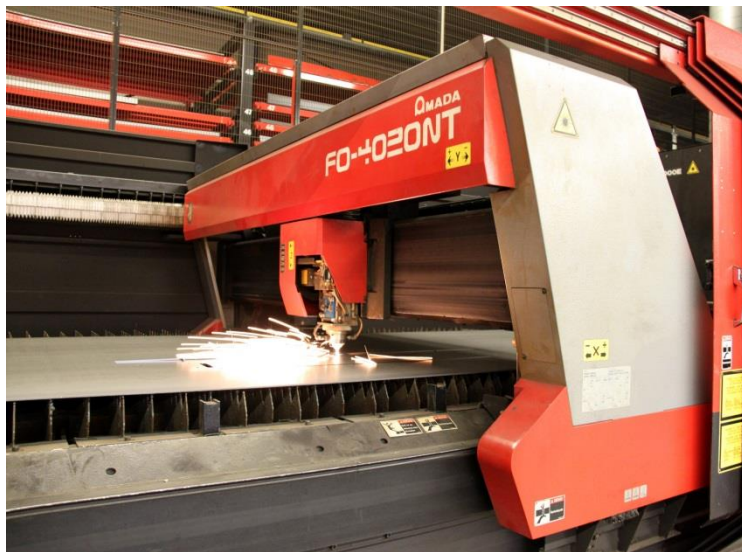
Obr. 1: Průmyslová laserová řezačka schopná řezat kov
