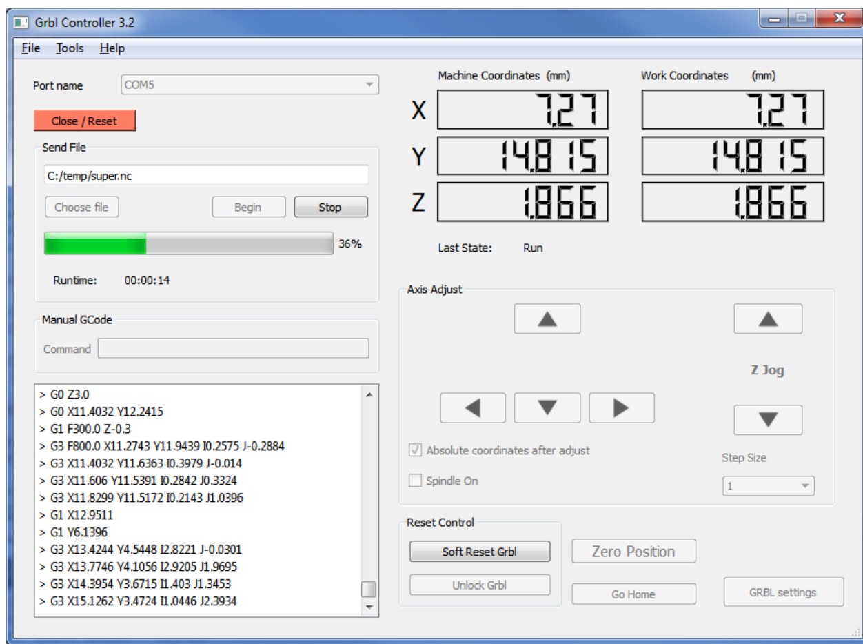
Obr. 21: Počítačový program GRBL Controller který komunikuje s Arduinem
