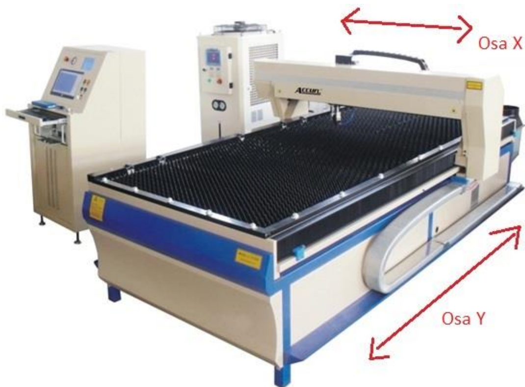
Obr. 3: Zvýraznění os pohybu na řezačce
