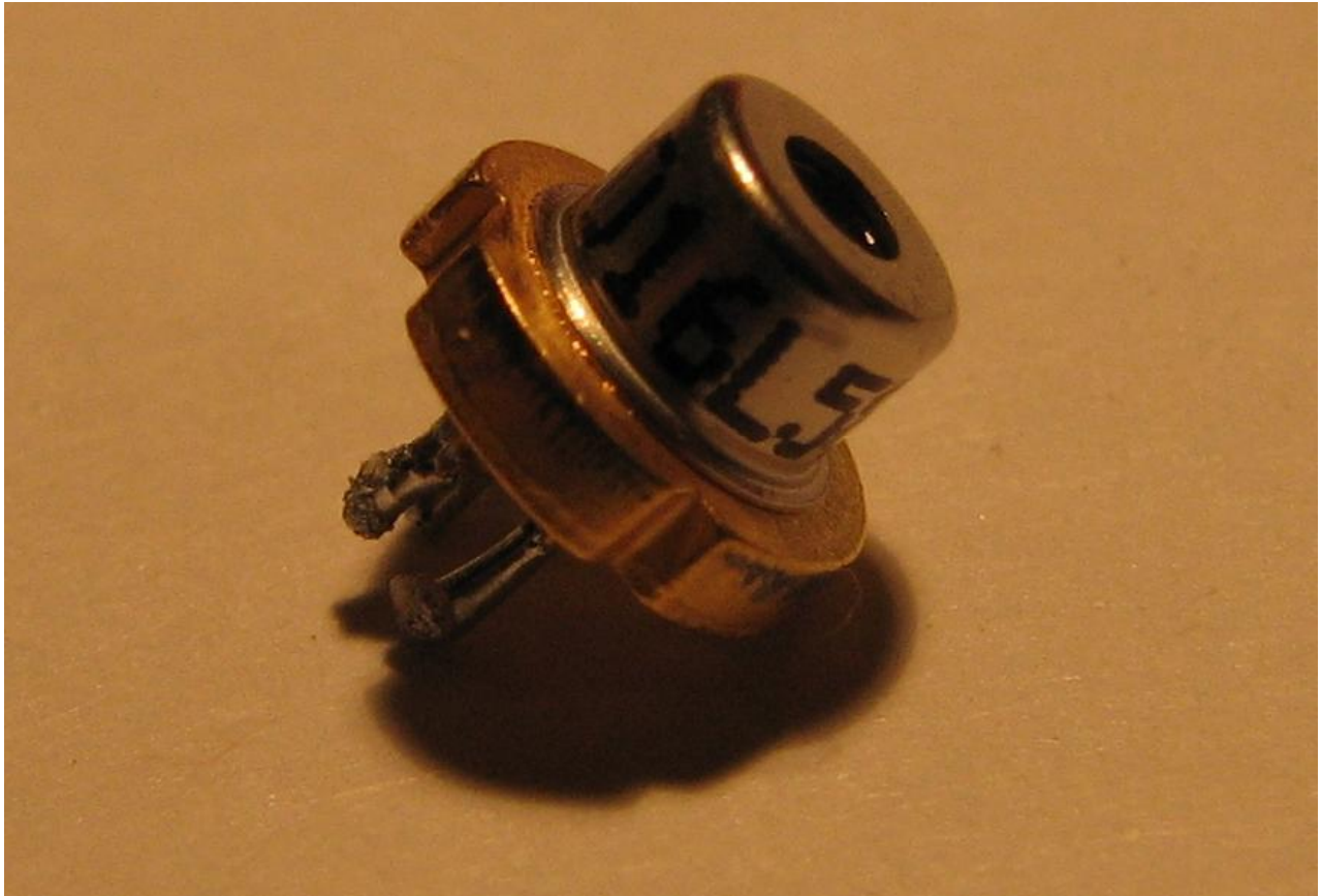
Obr. 18: Laser z diskové mechaniky
