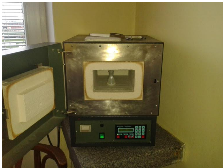
OBRÁZEK 10: ERLLENMEYROVA BAŇKA SE SUBSTRÁTEM V MUFLOVÉ PECI
