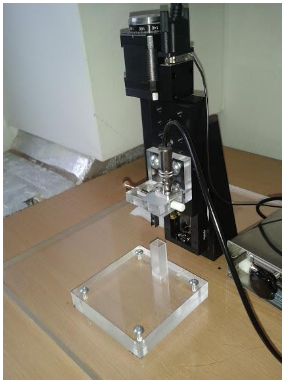
OBRÁZEK 8: APARATURA PRO DIP-COATING 2
