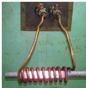
Obr. 3 Ohřev vsázky válcového tvaru
