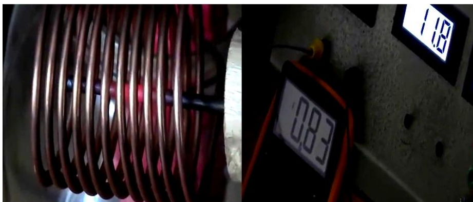
Obr. 11 Ukázka nastaveného LC obvodu který indukuje výkon do vsádky
