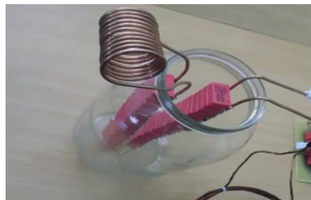
Obr. 7 LC obvod (vzduchová cívka, foliové kondenzátory).
