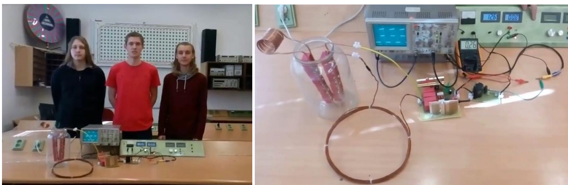
Obr. 12 a Obr. 13 Pracoviště experimentu (digitální multimetry, panelový zdroj stejnosměrného napětí, regulovaný zdroj vnějšího stejnosměrného napětí, dvoukanálový osciloskop HM-1505 a běžné elektrotechnické pomůcky).
