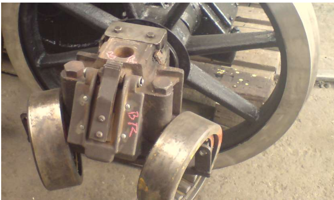
Obrázek 26: Detail domku zatíženého závažími před repasí na skutečném voze
