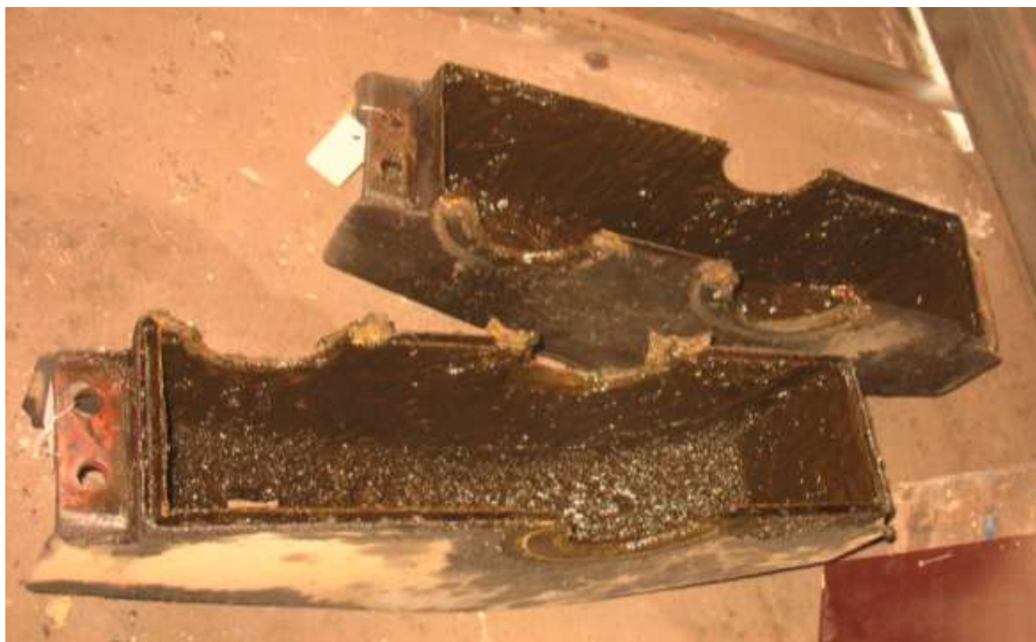
Obrázek 25: Stav skutečné převodovkové skříně před repasí
