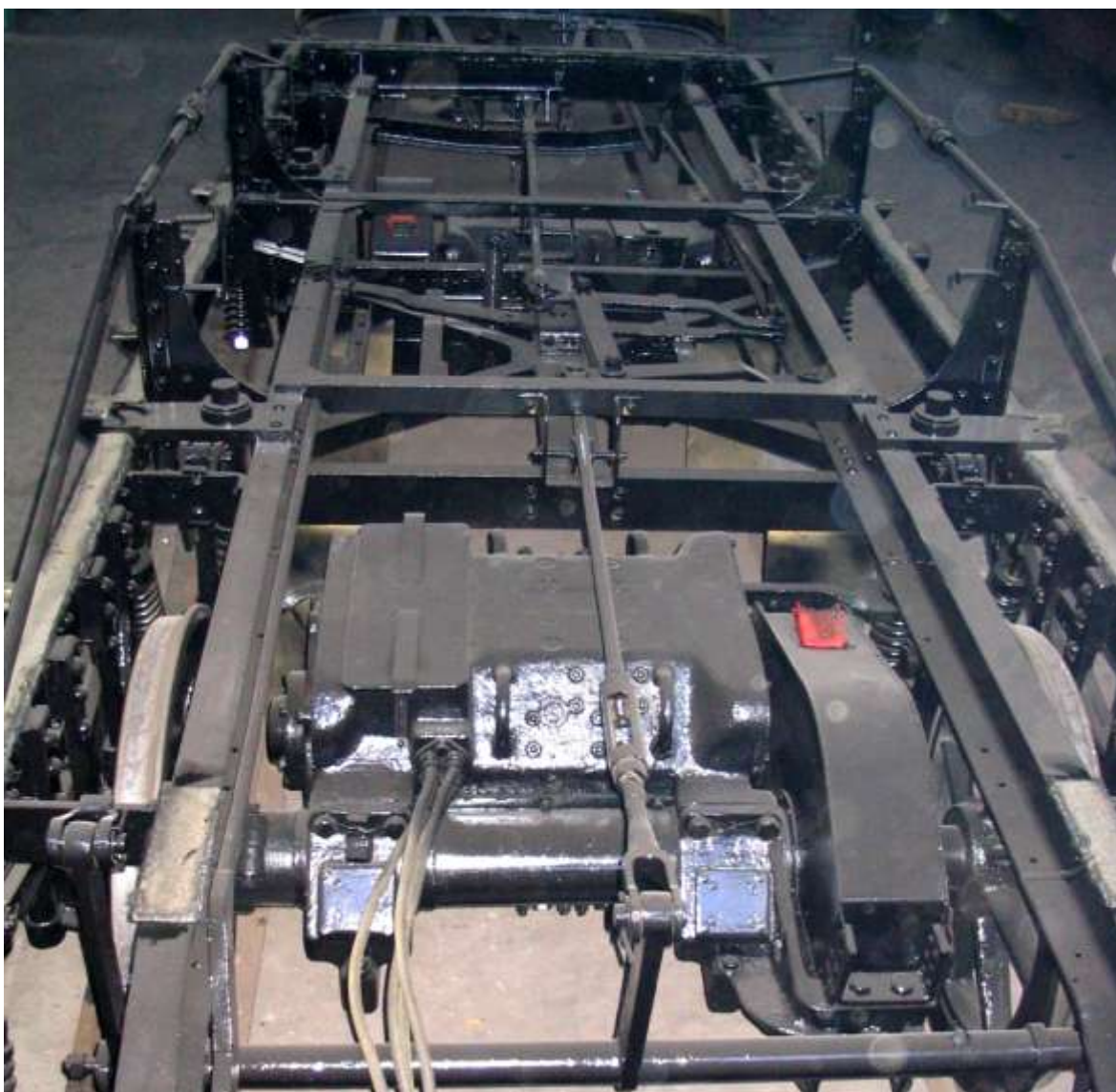
Obrázek 6: stav rámu skutečného rámu po repasi
