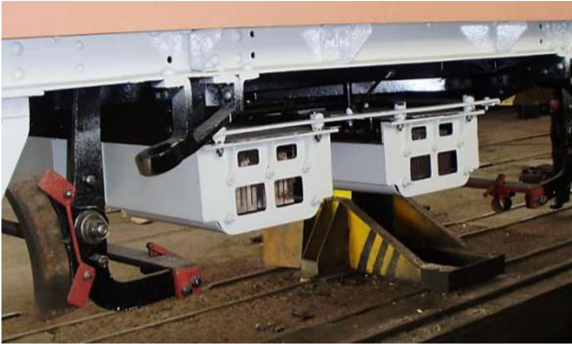
Obrázek 39: Stav odporníků po repasi umístěných na skutečném vozidle
