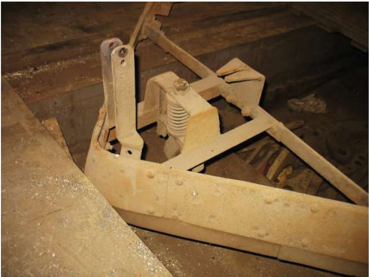
Obrázek 45: Stav skutečného pluhu před repasí
