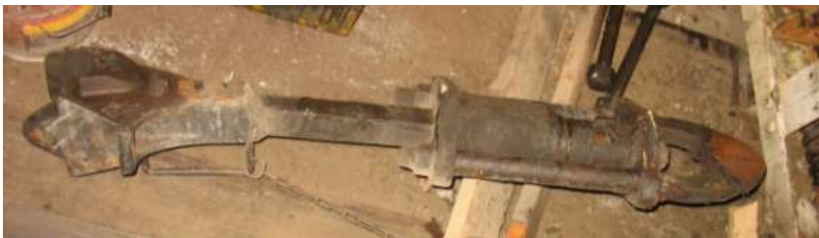
Obrázek 9: Spřáhlo ze skutečného vozu před repasí
