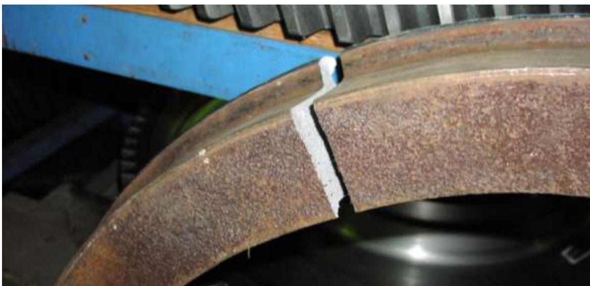
Obrázek 20: Detail rozříznuté obruče kola ve skutečnosti
