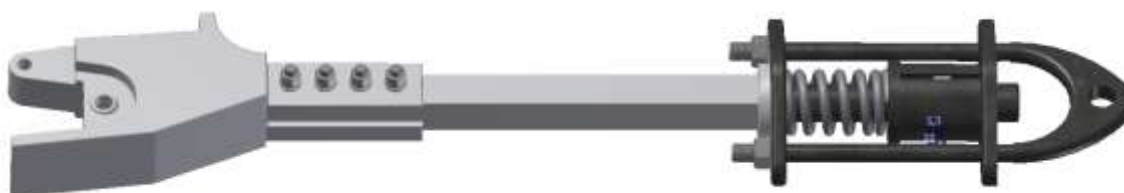
Obrázek 10: Spřáhlo ve 3D modelu
