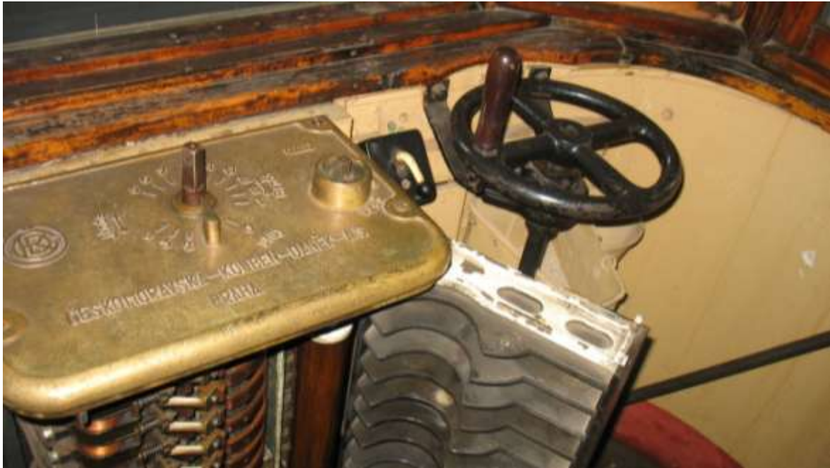
Obrázek 37: Řídicí pult v kabině řidiče u skutečného vozidla před repasí
