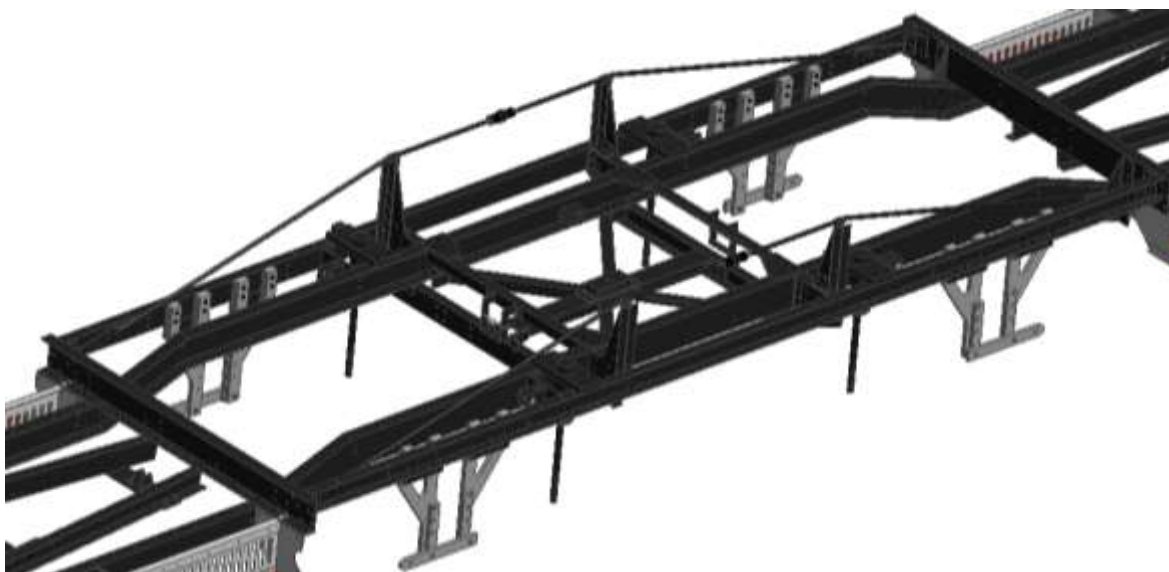
Obrázek 5: Detail střední části rámu na 3D modelu
