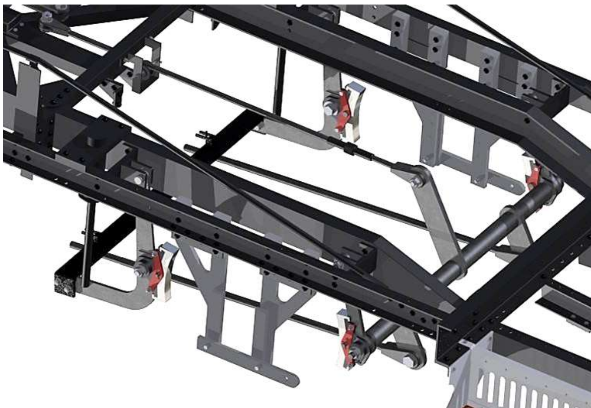
Obrázek 58: Detail brzdového mechanismu ve 3D modelu
