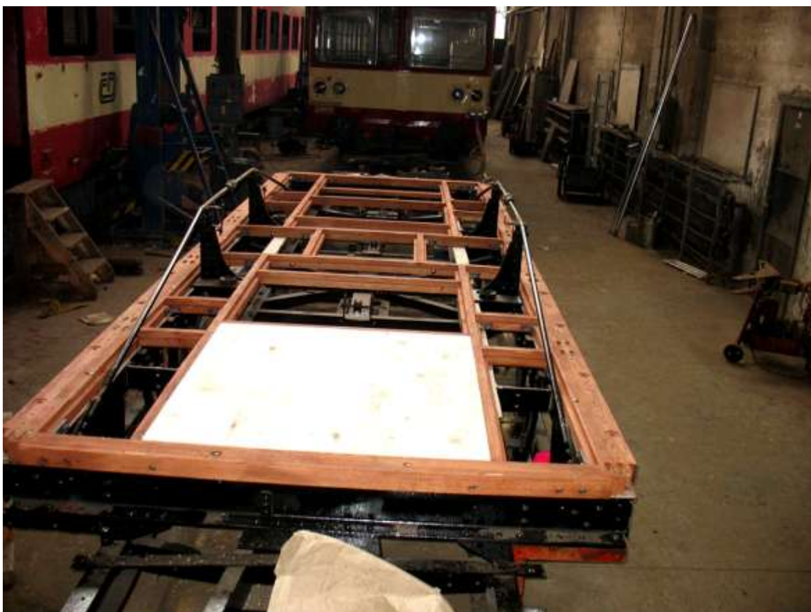
Počátek montáže kabiny na zrenovovaný rám tramvaje
