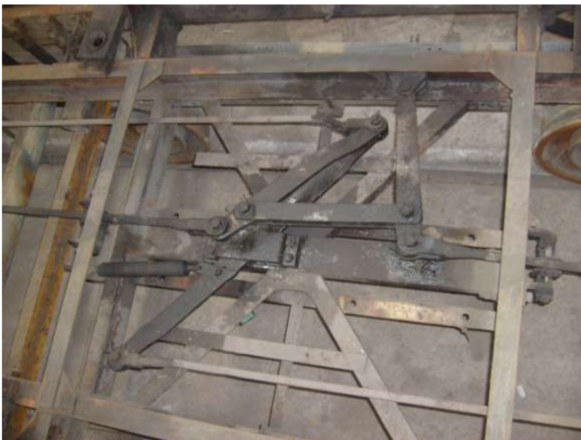
Obrázek 4: Detail křížového spoje před repasí na skutečném vozidle
