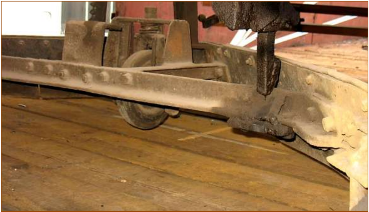
Obrázek 44: Detail zadní části pluhu před repasí na skutečném vozidle
