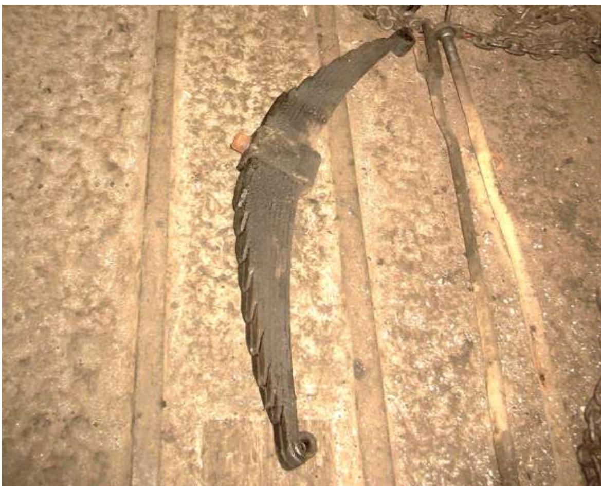
Obrázek 34: Stav listové pružiny před repasí na skutečném voze
