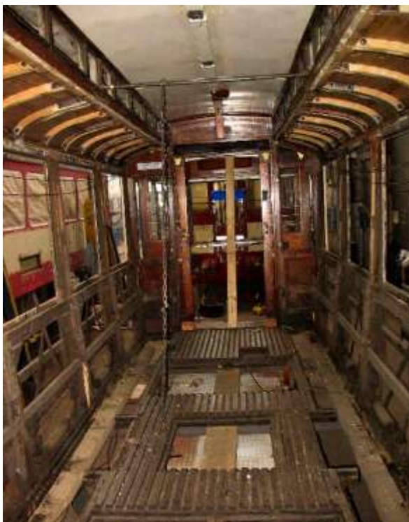
Vnitřní pohled na kabinu před repasí
