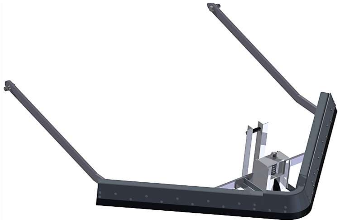
Obrázek 43: Pluh ve 3D modelu
