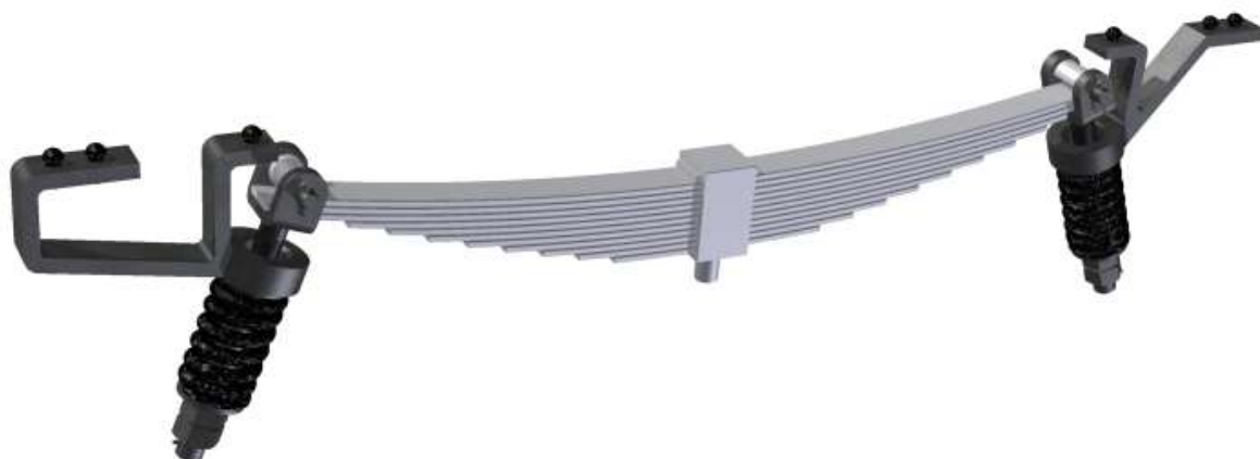
Obrázek 35: Detail odpružení rámu ve 3D modelu
