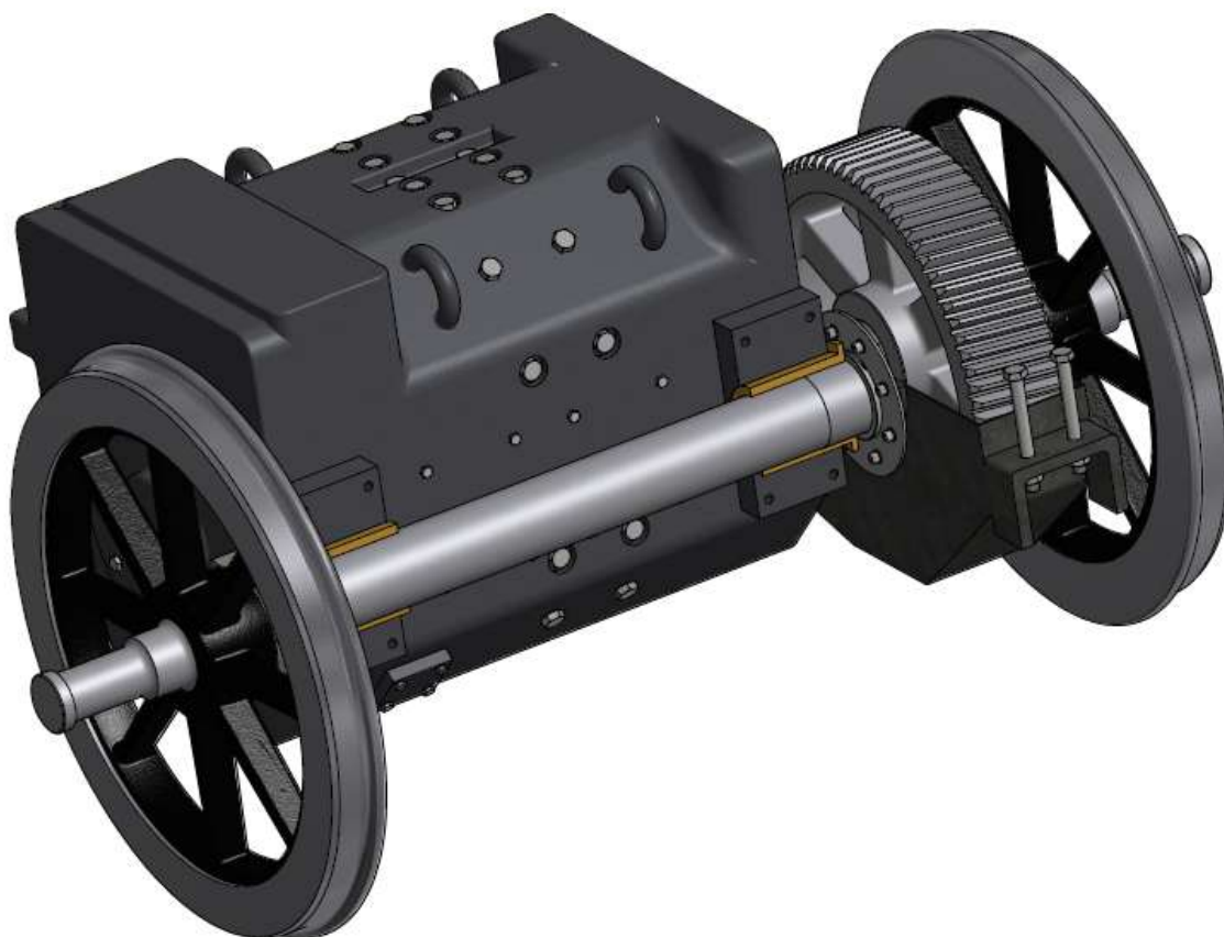
Obrázek 16: Detail demontované nápravy v 3D modelu
