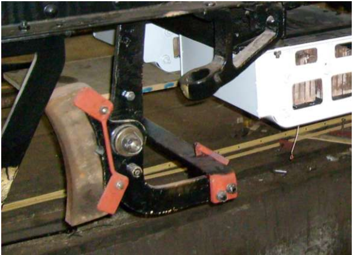
Obrázek 57: Stav části brzd po repasí a nalakování na skutečné tramvaji č. 223
