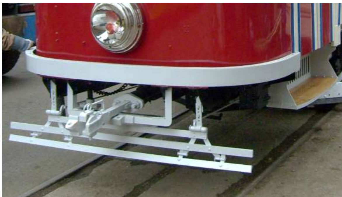
Obrázek 49: Stav čelní zábrany po repasi na skutečném voze
