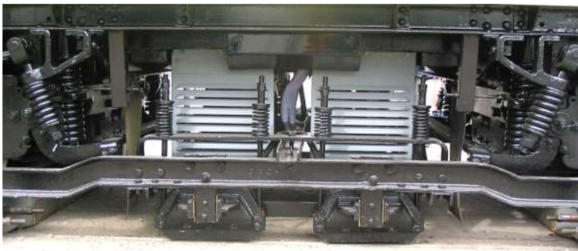
Obrázek 52: Prostor pod rámem včetně přidáné elektromagnetické brzdy u pražského vozu č. 2210
