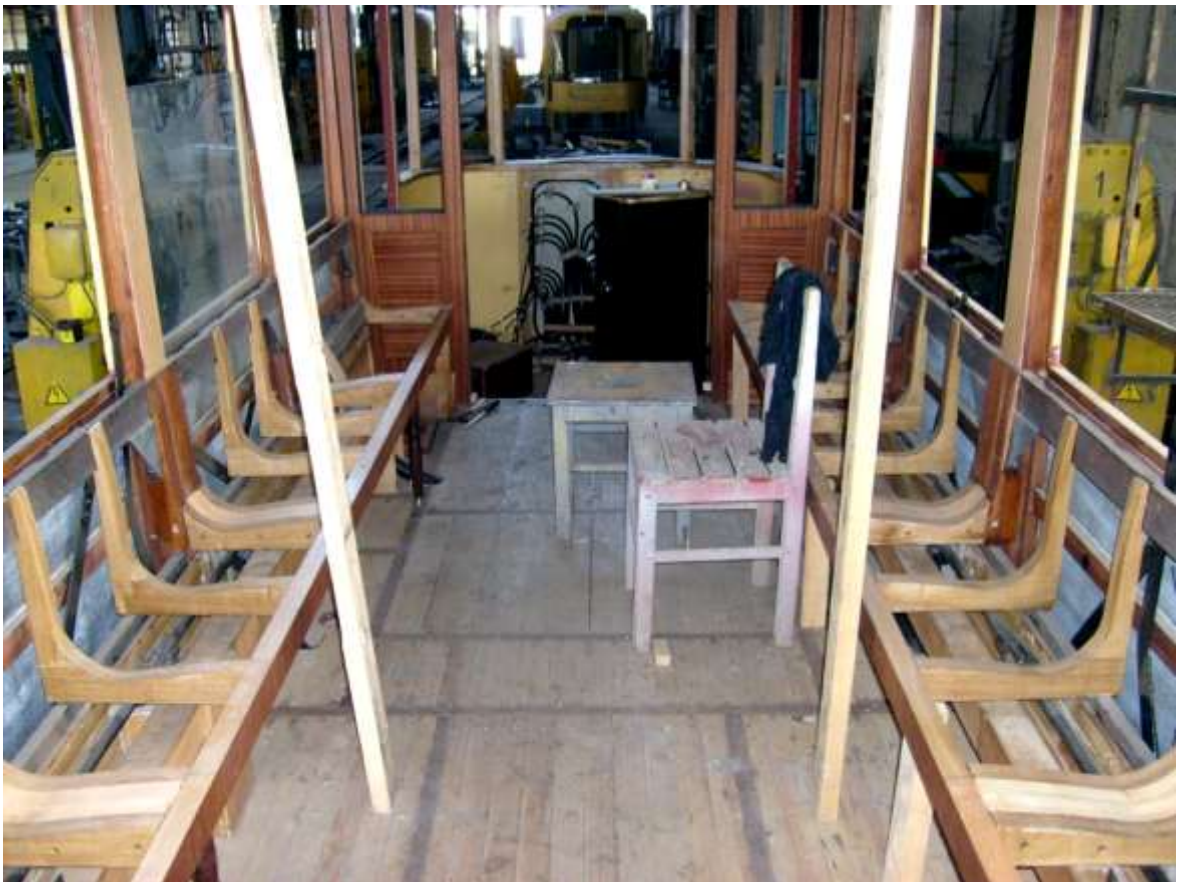
Kabina pro cestující během montážních prací
