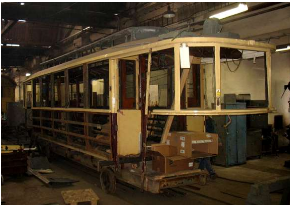
Kostra kabiny při rozebírání v dílnách
