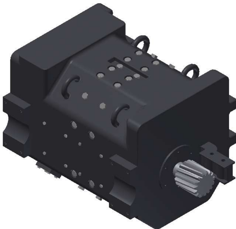
Obrázek 18: Motor historické vozu ve 3D modelu
