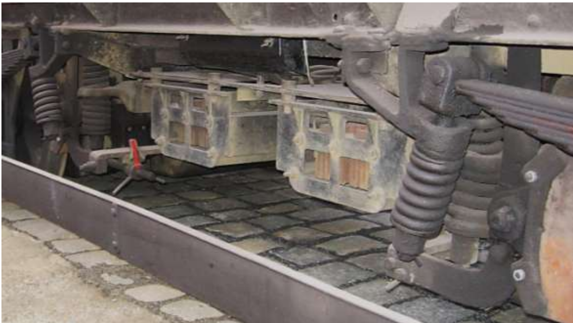
Obrázek 38: Stav odporníků před repasí na skutečném voze
