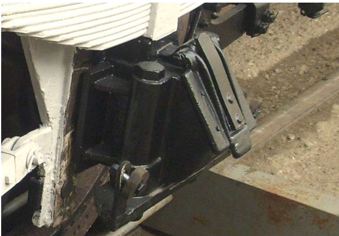
Obrázek 27: Detail domku po repasi na skutečném vozidle
