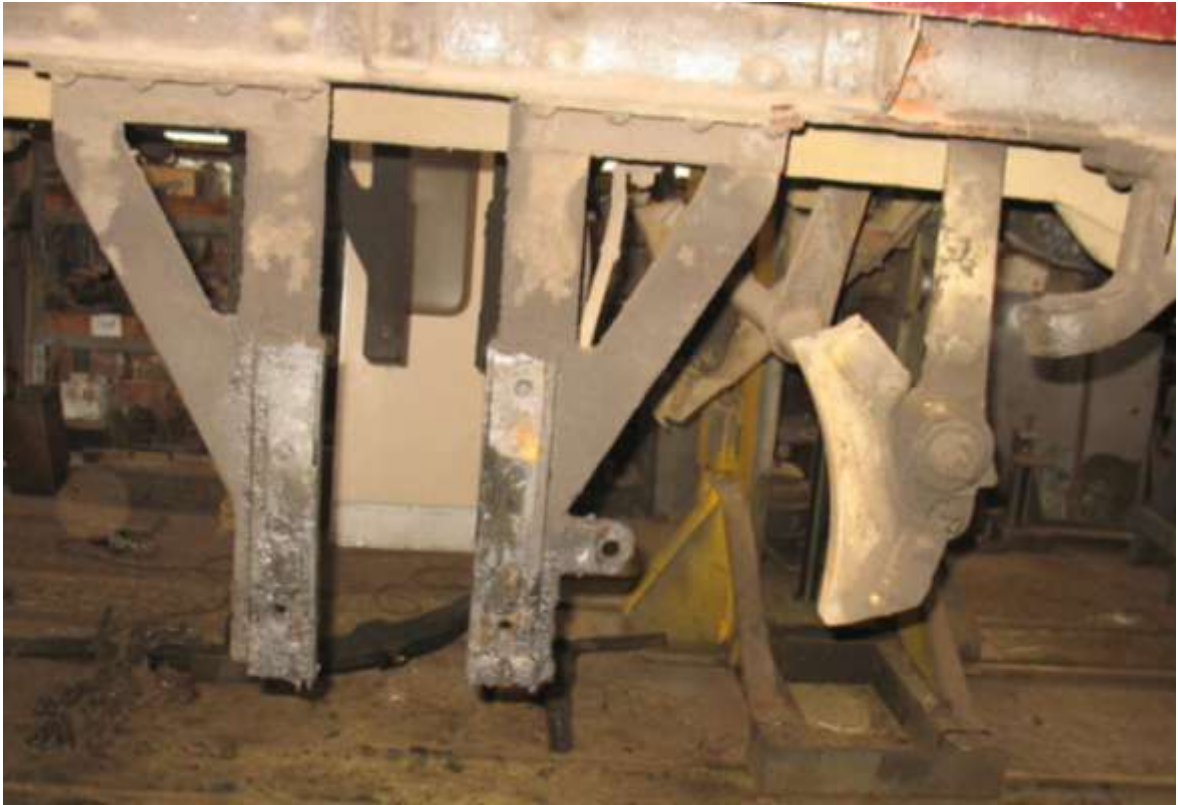
Obrázek 56: Stav brzdové páky a brzdového uzlu před repasí skutečného vozidla
