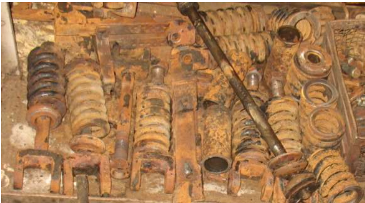
Obrázek 30: Stav spirálových pružin před repasí na skutečném vozidle
