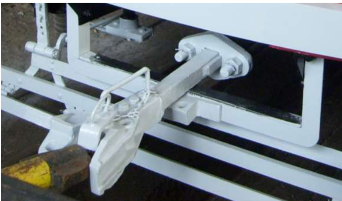
Obrázek 11: Spřáhlo po repasi během posunu na skutečném voze
