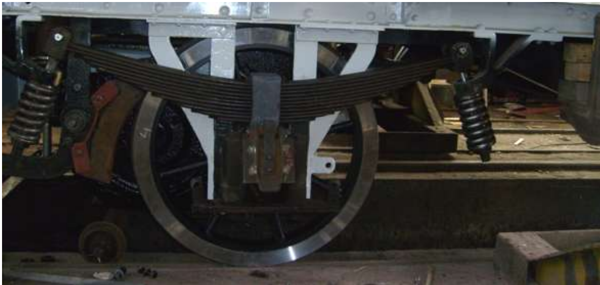
Obrázek 33: Detail odpružení na skutečném vozidle č. 223
