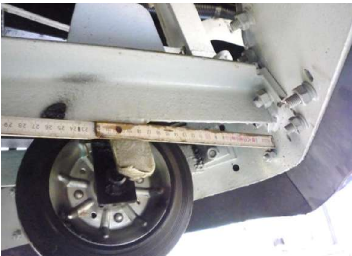
Obrázek 46: Detail ochranného kola na pluhu po repasi
