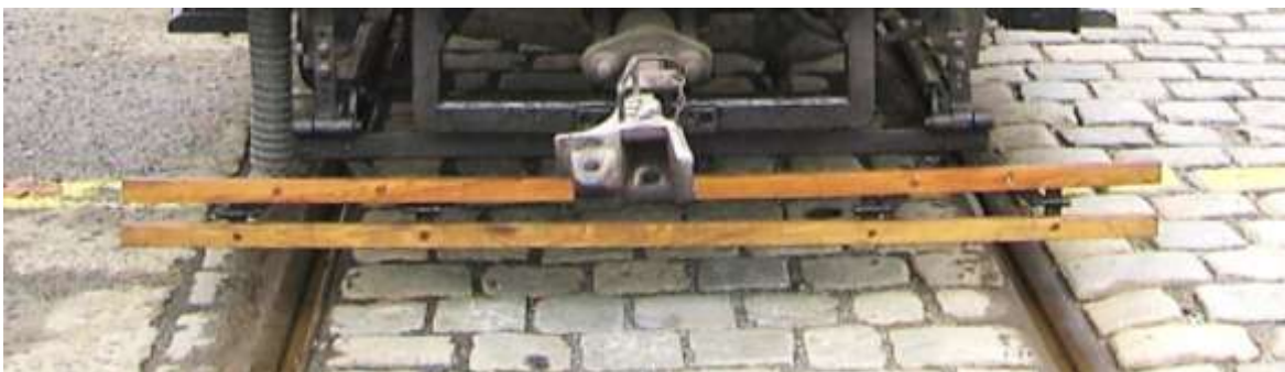
Obrázek 47: Čelní zábrana na skutečném vozidle před repasí
