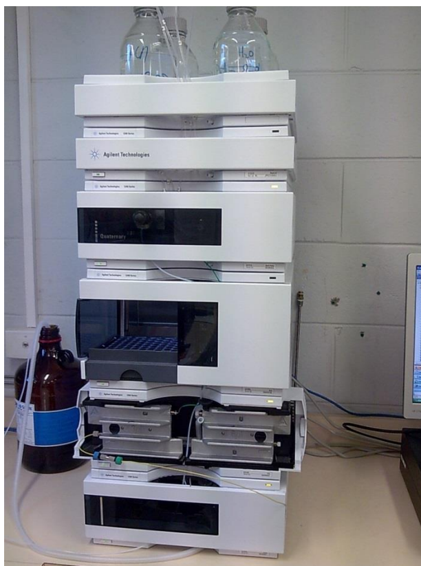
Obrázek 21 Kapalinový chromatograf Zdroj: wikipedia.com
