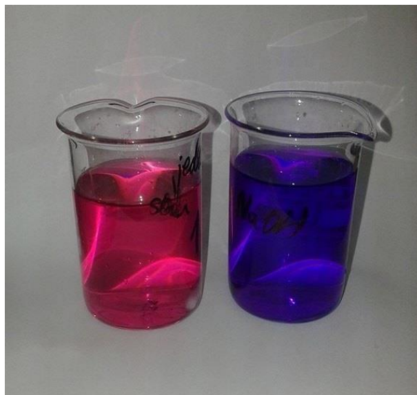
Obrázek 25: Titrace 2, vzorek před a po změně barvy Zdroj: vlastní zpracování
