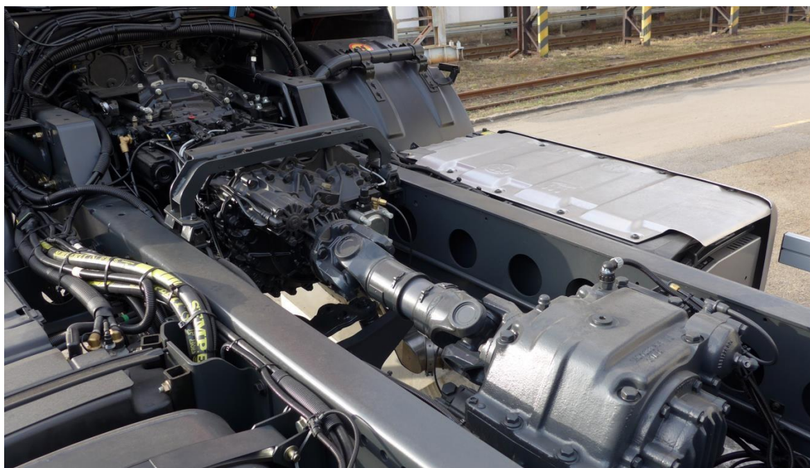
Obr. 43 – T 158 Phoenix, spojení převodovky se sestupnou převodovkou a pomocný rám
