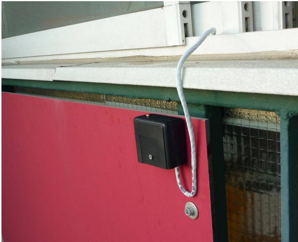
Obrázek 3: Konstrukční box se senzory připevňný k vnější straně lodžie (raná fáze vývoje)
