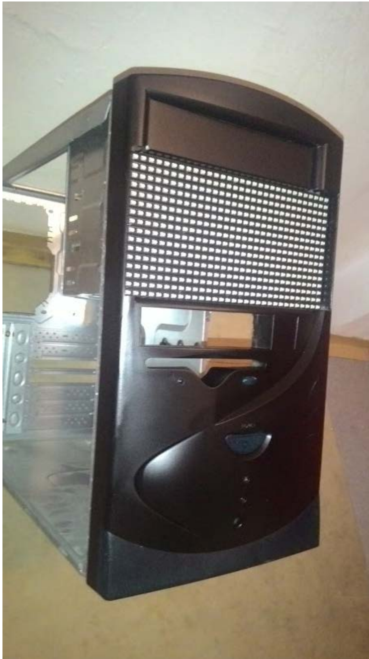
Obr. 21 – Vsazení displeje do skříně a přesříkaná skříně
