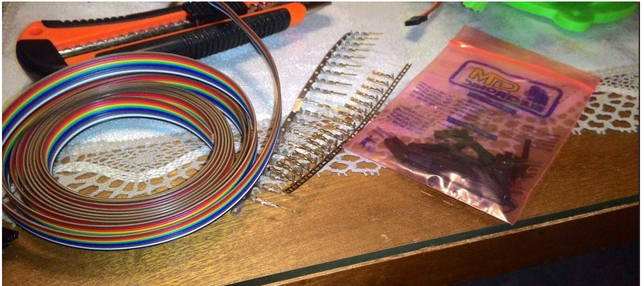
Obr. 24 – Příprava kabelů na prodloužení vývodů ze servo motorů
