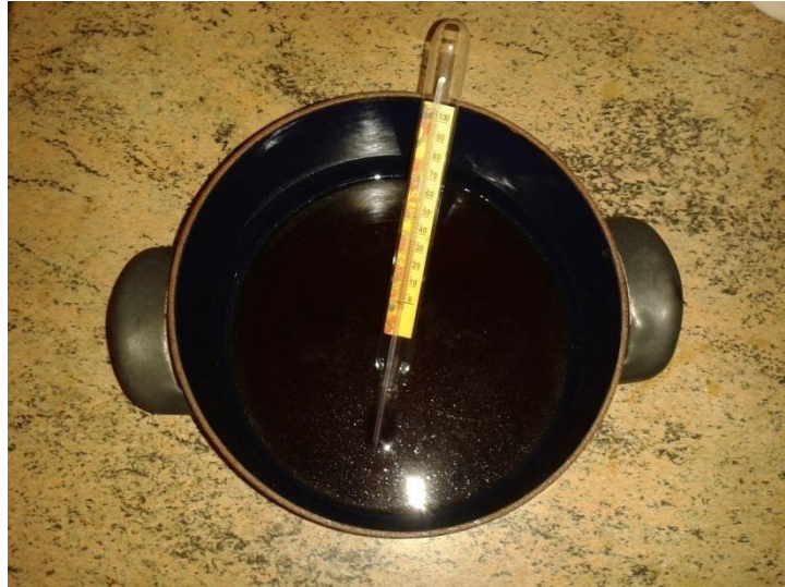
Obrázek č. 4 Rostok NaOH s H 2 O a barvivem – kontrola správné teploty
