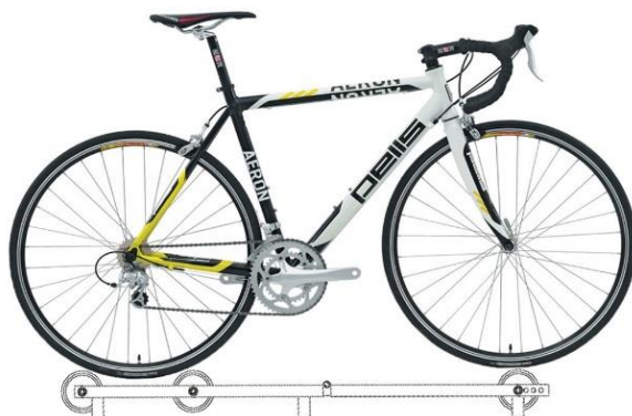
Obr. 4.1: Schéma provozu cyklistických válců
