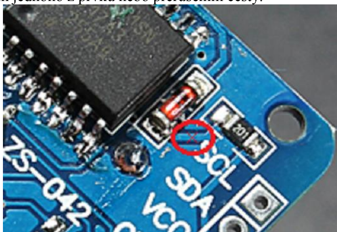
Obrázek 41 Dobíjecí obvod baterie
