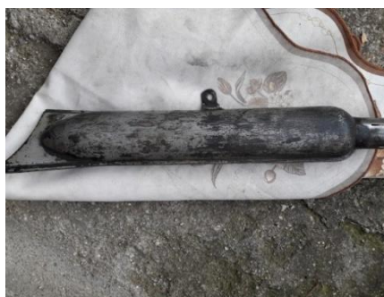
Obrázek 36 Tlumič výfuku po čištění ocelovým kartáčem
