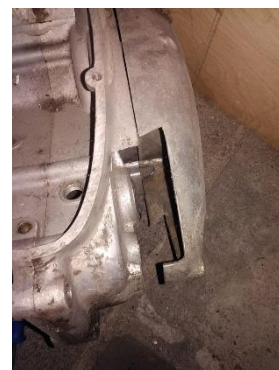
Obrázek 31 Výřez v motoru pro kryt řetězu Jawa-ČZ 150/353
