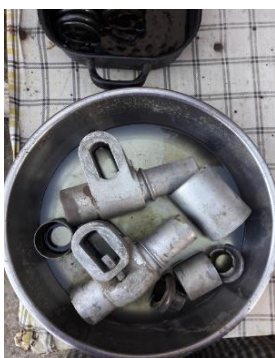
Obrázek 40 Čištění pouzder a kluzáků v starého chromu. Následně jsem kluzáky přebrousil smirkovým papírem o drsnosti P240. Tímto způsobem
