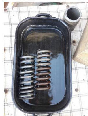
Obrázek 41 Čištění pružin v technickém benzínu
