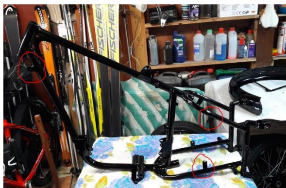
Obrázek 49 Rám po opravě a renovaci
