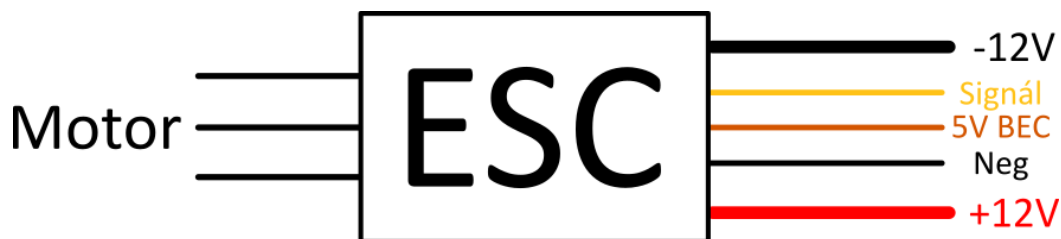
Obrázek 1 Schéma vodičů vycházejících z ESC a zapojených do ESC (není-li uvedeno jinak, obrázek autor)
