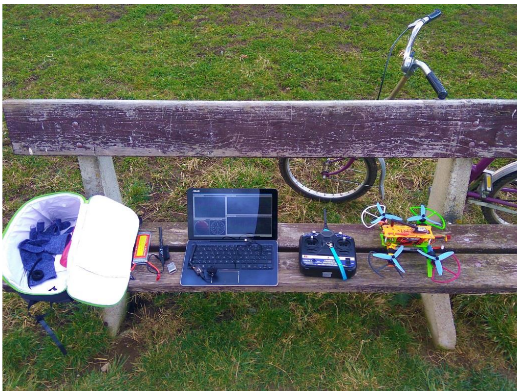
Obrázek 18 Pohled na měřicí stanoviště, zleva: batoh s rukavicemi, nápojem a náhradními velcro stahovacími páskami (černé klubo), sekundární baterie (šedo-červeno-žlutá), přijímač FPV signálu (černá krabička s anténou a drátem), měřič napětí na bateriích (šedá krabička), počítač s měřícím programem LibrePilot, modul OPLink mini (černý s anténou na klávesnici), ovladač drona a dron 1318 . Za lavičkou ekologický dopravní prostředek bicykl.
