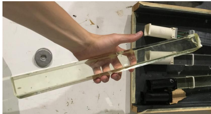
Obrázek 25: Krystalický scintilátor z detektoru KOMPAS.
