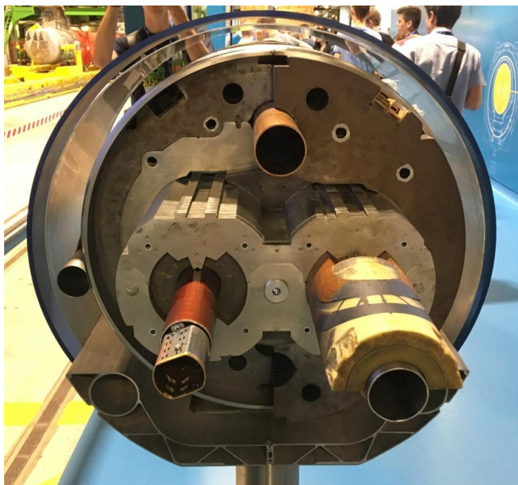
Obrázek 4: Fotografie průřezu dipólového magnetu v tubusu. (Pořízena v CERNu na HSSIP programu.)
