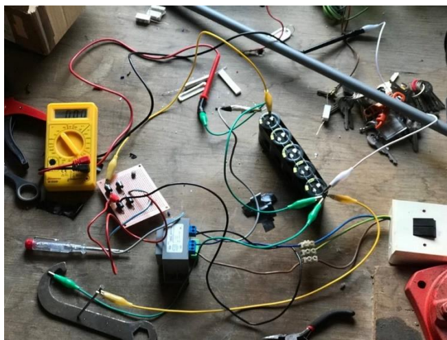
Obr. 35: Testování kondenzátorové banky nabíjené transformátorem Vlastní obsah
