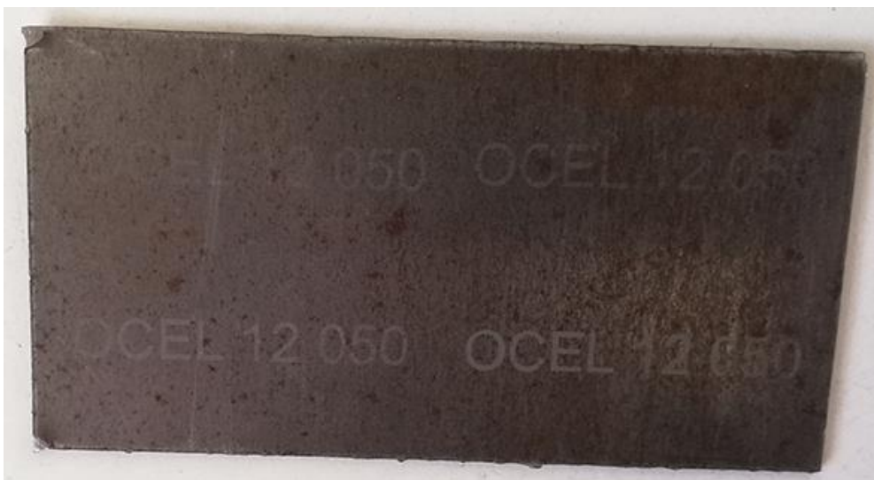
Obrázek 34: Zkouška na ocel 12 050 - rychlost 25%
