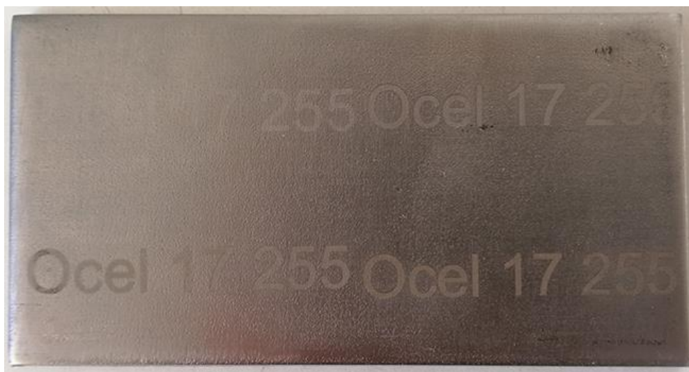
Obrázek 37: Zkouška na ocel 17 255 - rychlost 10%
