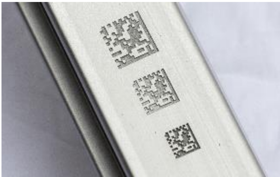
Obrázek 7: příklad laserově vygravírovaného QR kódu
