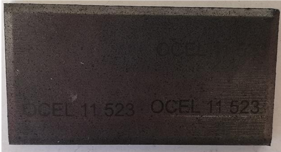
Obrázek 32: Zkouška na ocel 11 523 - rychlost 25%
