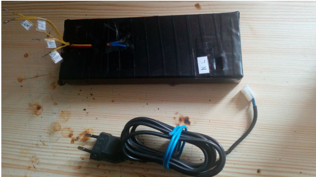
Obr. 1: První prototyp laboratorního zdroje, který jsem si vytvořil ještě před oznámením ročníkových prací vyrobený z napájecího zdroje DVD přehrávače. To mě inspirovalo k vytvoření lepší verze.
