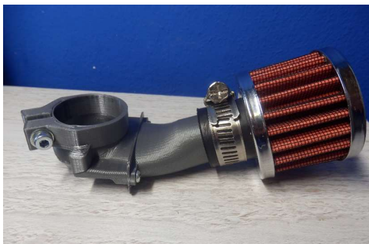
obr. č. 5. vytištěný díl s namontovaným vzduchovým filtrem
