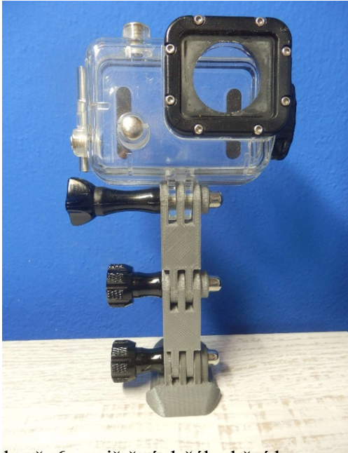
obr. č. 6. vytištěný držák akční kamery s pouzdem
