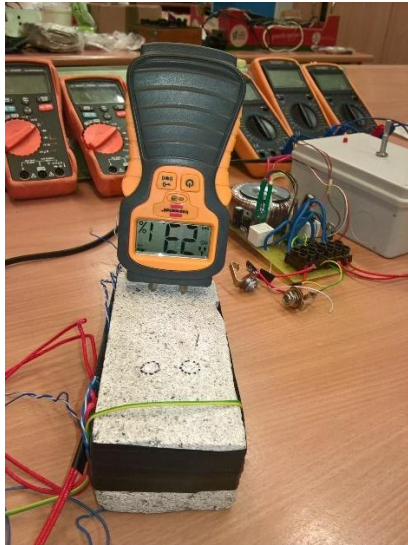
Obr.6 Měření vlhkosti v betonu
