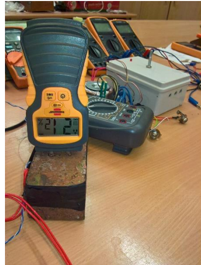
Obr.7 Měření vlhkosti v cihle
