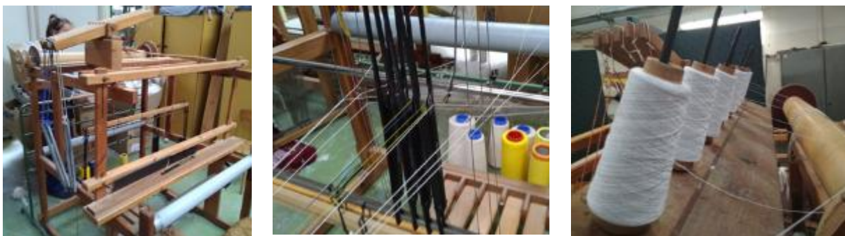
Obr. 3, 4, 5: Tkalcovský stav; navedení osnovních nití; cívky s osnovou [1]
