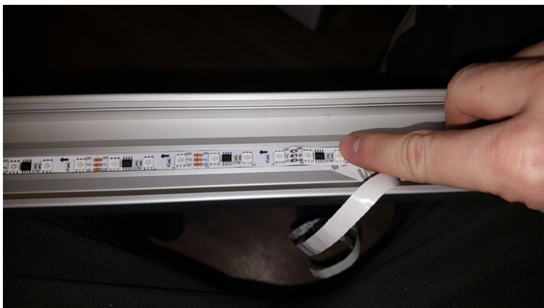
Obr. 3.7 Lepení LED pásku do profilu
