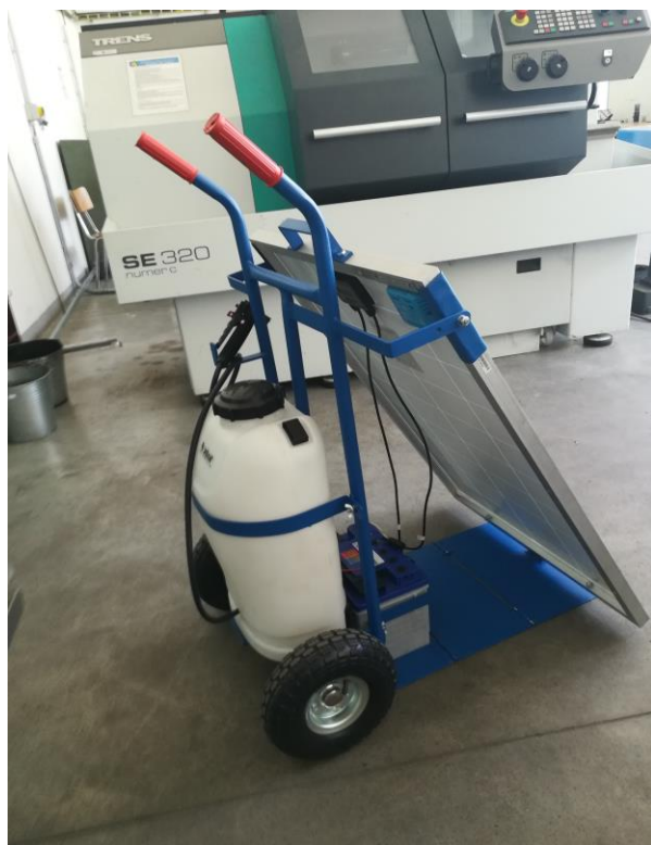
Obr. 2 kompletace v zámečnické dílně v rozloženém nabíjecím stavu
