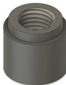
Obrázek 44 Model šroubení výpustního a napouštěcího šroubu
