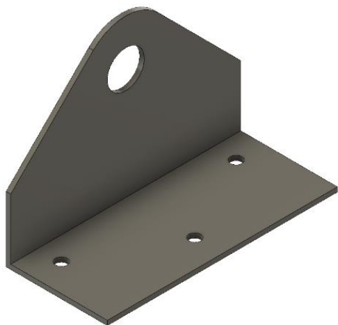
Obrázek 37 Model držáku pro klikovou hřídel (bez ložiska)
