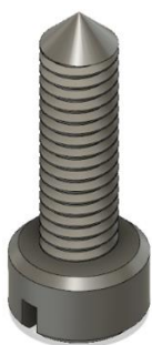
Obrázek 18 Model stavěcího šroubu pojistného ventilu
