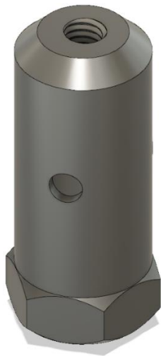
Obrázek 16 Model těla pojistného ventilu
