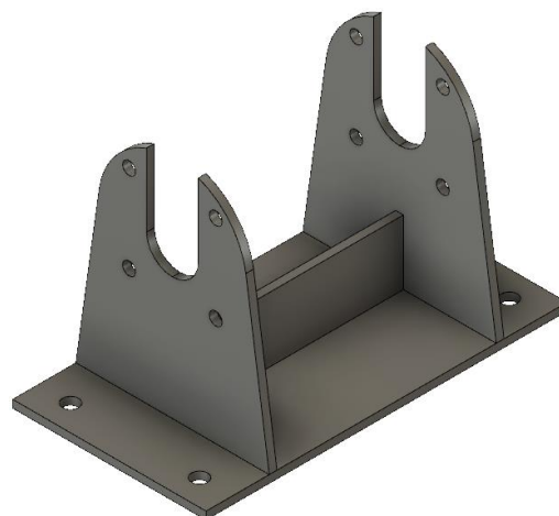
Obrázek 38 Model držáku pro válec
