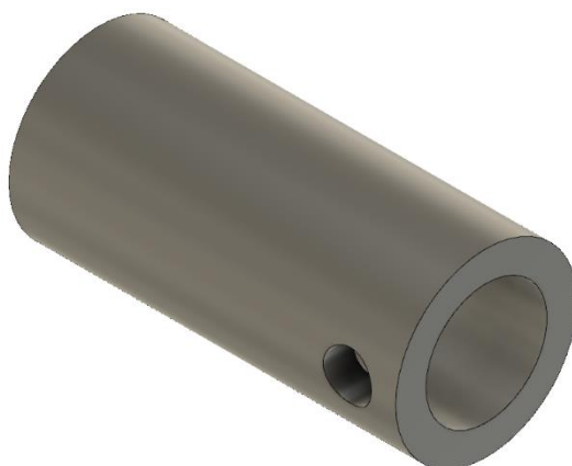
Obrázek 25 Model těla válce
