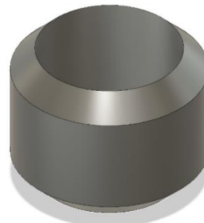
Obrázek 40 Model těsnícího soudku k převlečenému šroubu
