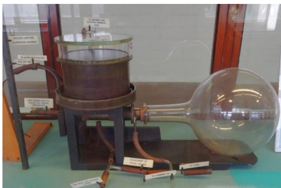
Obrázek 1 Originální expanzní mlžná komora (1)
