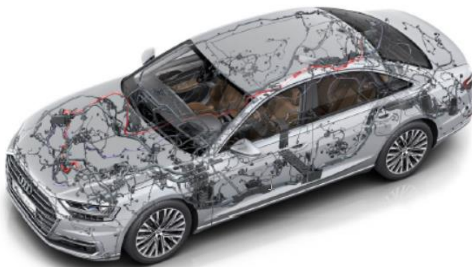
Obr.5 Ilustrační schéma vedení komunikačních kanálů, senzorů a řídicích jednotek ve vozidle Audi A8 2018 [10]
