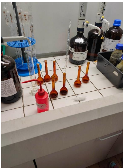
Obr. 17: Dolévání baněk s etherovou fází methanolem – foto autor
