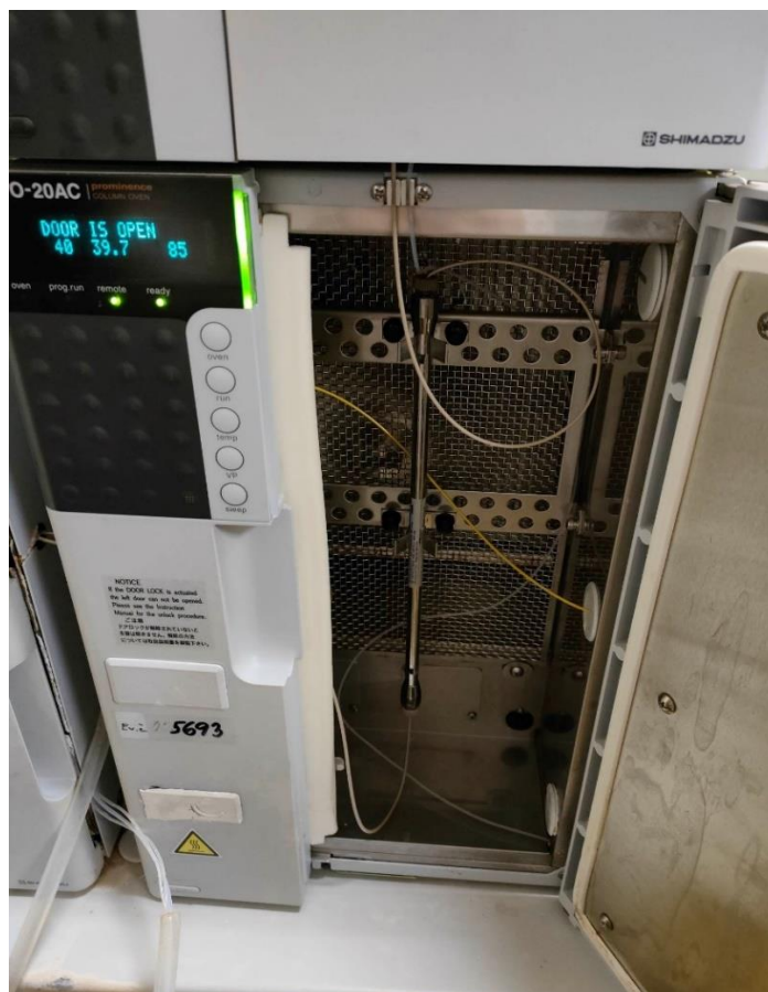
Obr. 10: HPLC Kolona umístěná v termostatu, v chromatografu – foto autor
