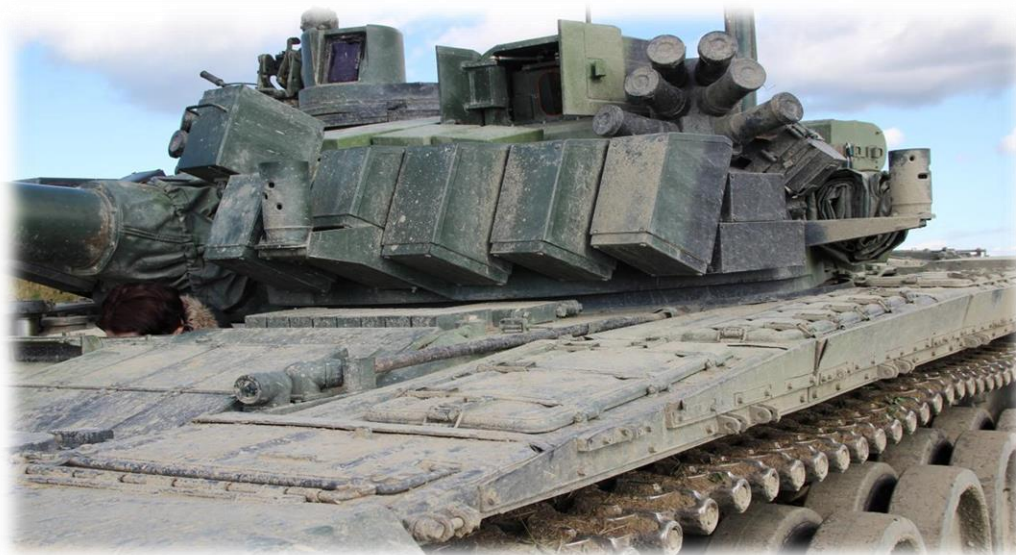
Obr. 9 Reaktivní pancéřování DYNA na tanku T-72M4CZ [12]
