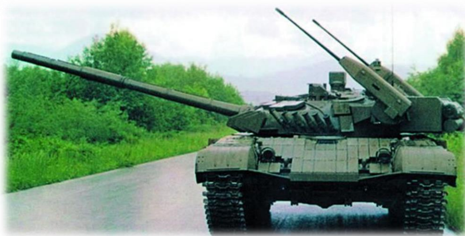
Obr. 4 Jediné dochovalé foto prototypu T-72M2 moderna s dvěma 20mm kanóny [8]
