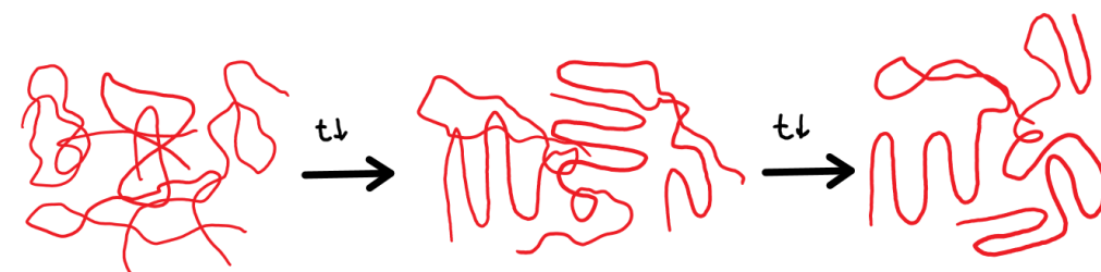
Obrázek 2.17: Vliv pozvolného poklesu teploty na semi-krystalický polymer
