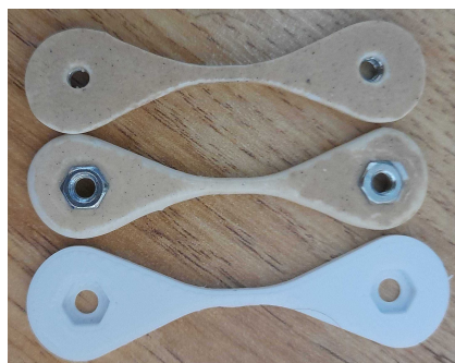
Obrázek 2.10: Vzorek PET-G 185°C 4h vs. neupravený vzorek
