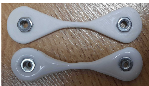
Obrázek 2.15: PET-G 165°C 2h Annealing vs. Zapékání v sádře
