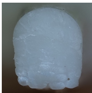
Obrázek 2.13: Průřez 2h v sádře pečeným podélným vzorkem PLA
