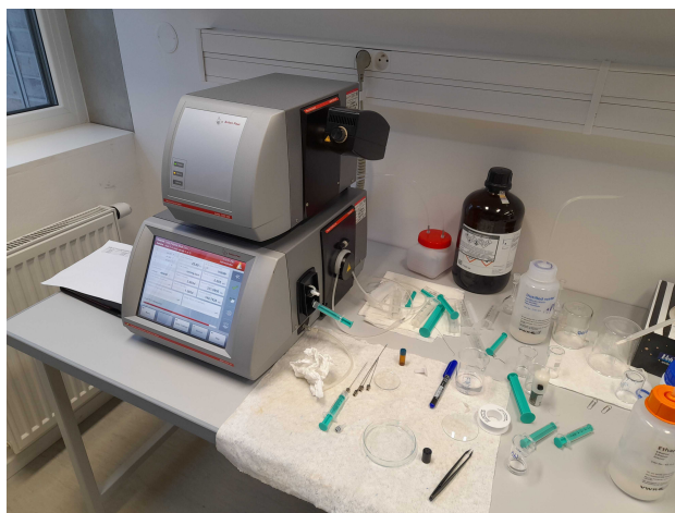
Obrázek 2.1: Viskozimetr s hustoměrem Anton Paar
