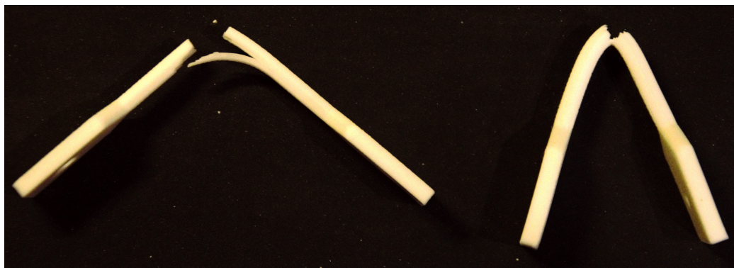
Obrázek 2.8: Zlomené vzorky, síla kolmá na rovinu vrstev
