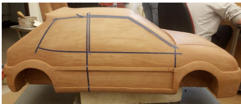
Obr. 56 Vytvoření linií oddělující jednotlivé panely karoserie
