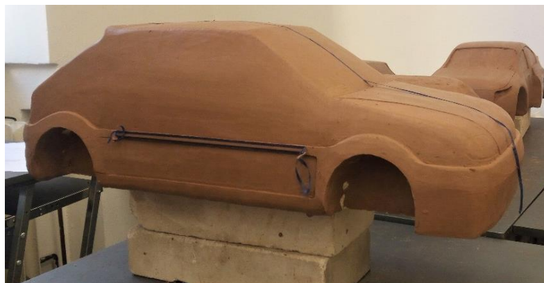
Obr. 47 Model automobilu po prvním uhlazení
