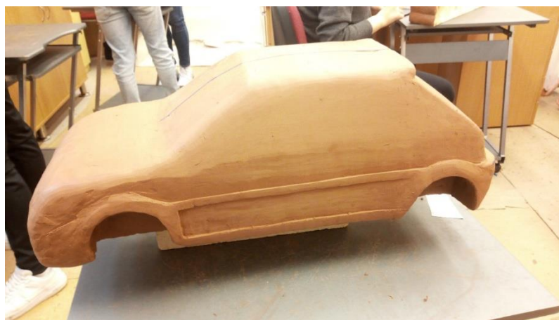
Obr. 46 Model automobilu po vytvoření hrubého tvaru
