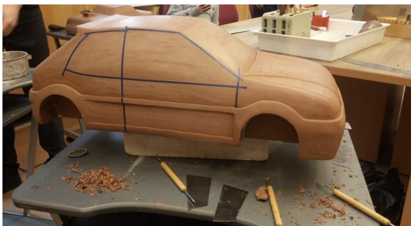
Obr. 55 Vytvoření linií oddělující jednotlivé panely karoserie
