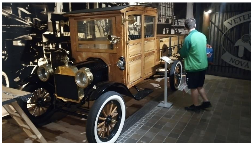
Obr. 5 – Opět Ford model T – zde lze vidět dřevěnou karoserii
