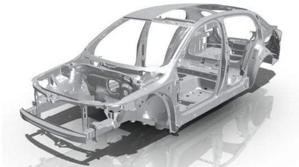
Obr.1 – moderní samonosná karoserie vozu Škoda Superb II
