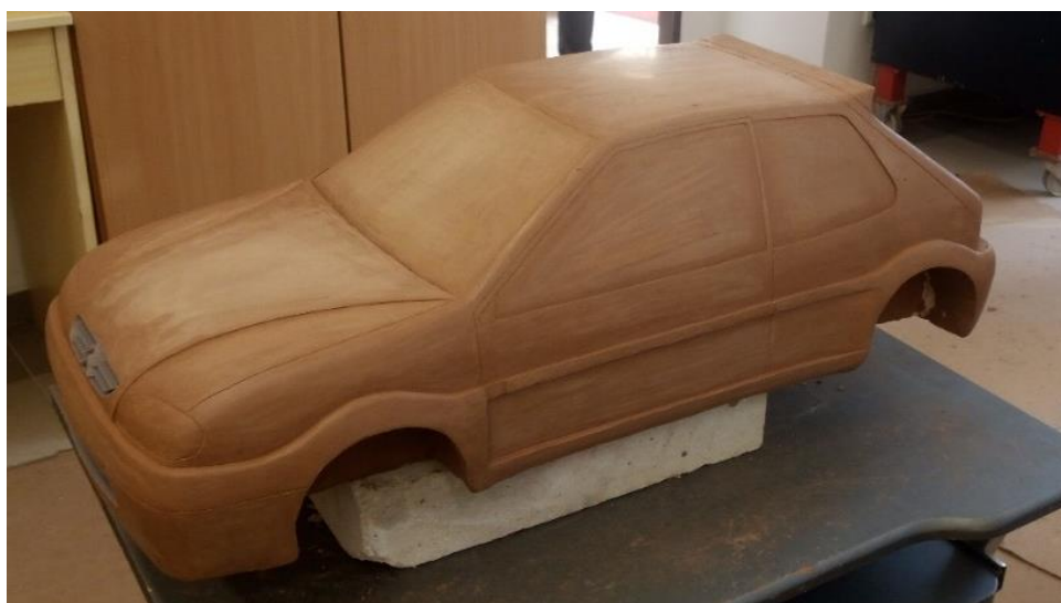
Obr. 58 Model v průběhu finálního vyhlazování
