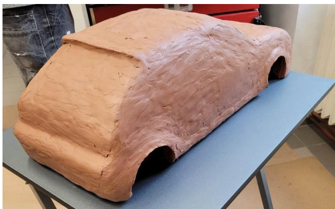
Obr. 43 Model automobilu po nanesení plastelíny
