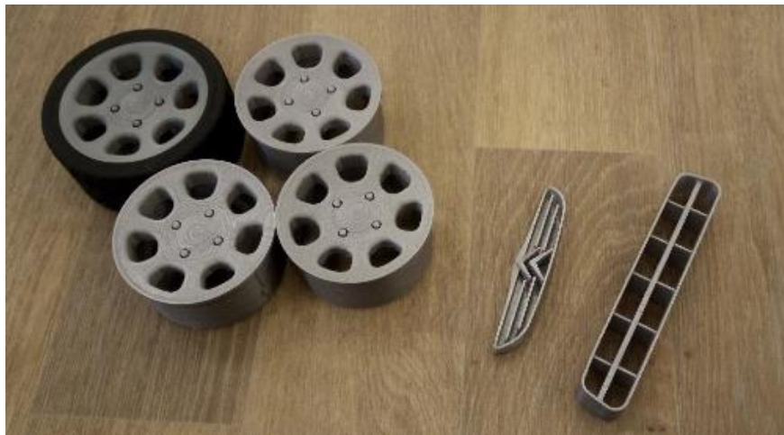
Obr. 52 Součásti modelu vytištěné na 3D tiskárně
