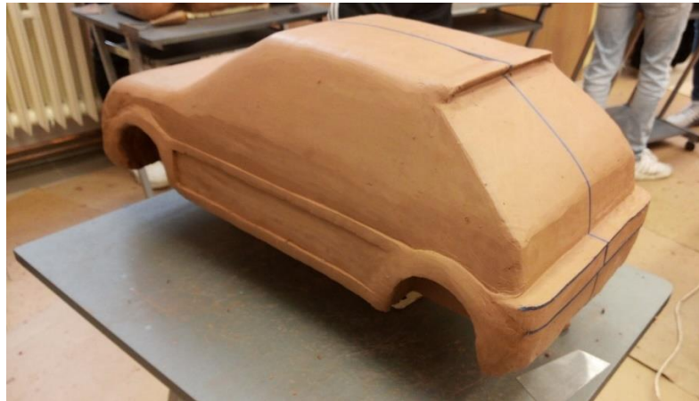
Obr. 45 Model automobilu po vytvoření hrubého tvaru
