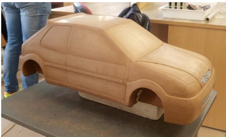
Obr. 57 Model v průběhu finálního vyhlazování
