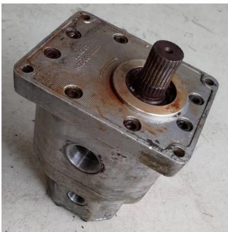
Obr. 1: Zubový hydrogenerátor ZCA 100+63 L 160-75
