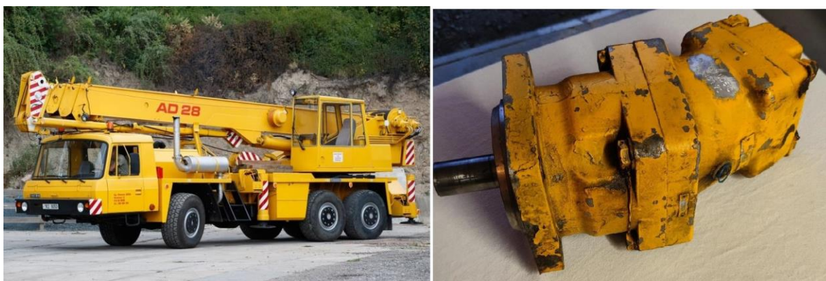
Obr. 6: Hydraulický axiální pístový motor AMK 25-7 RS použitý v autojeřábu Tatra 815 AD 28
