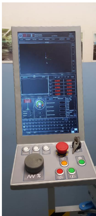
Obr. 2: Ovládací panel s dotykovým displejem stroje
