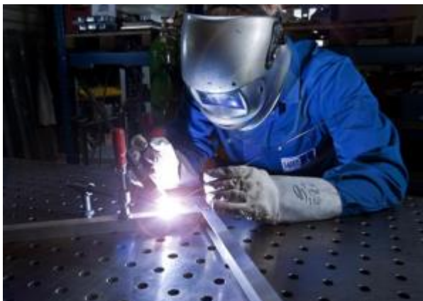
Obrázek 16: Ukázka pracovníka při svařování metodou WIG
