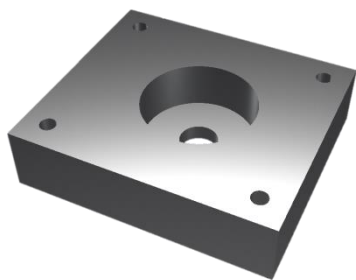
Obrázek 20: Kryt pro ložisko na straně u motoru
