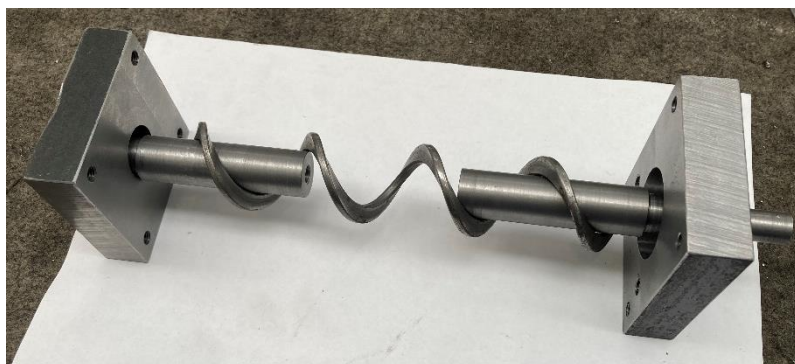
Obrázek 38: Složení hřídele a křivů na ložiska
