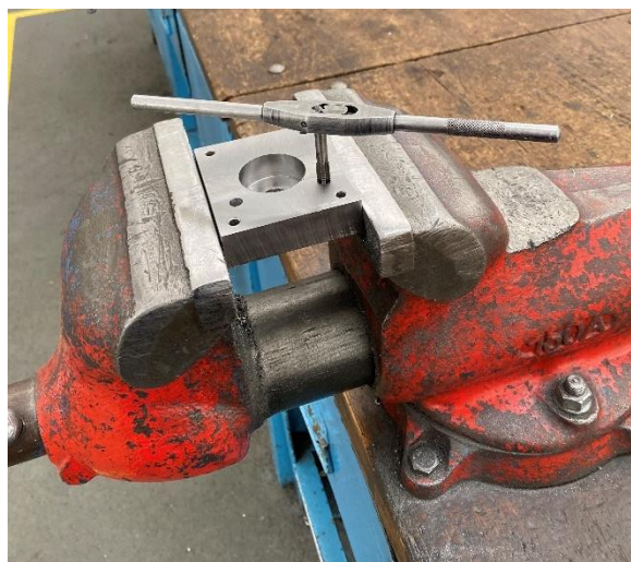
Obrázek 35: Vrtání závitu ručním závitníkem
