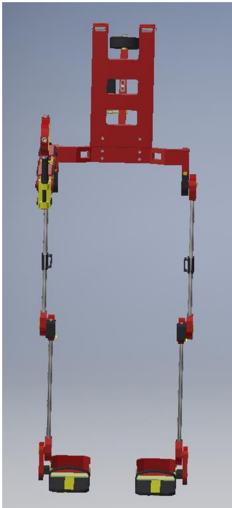
Obrázek 17: Finální průmyslový exoskelet z přední strany
