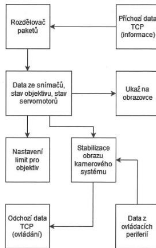
obr. 21 – Blokové schéma ovládání kamerového systému na straně ovladače
