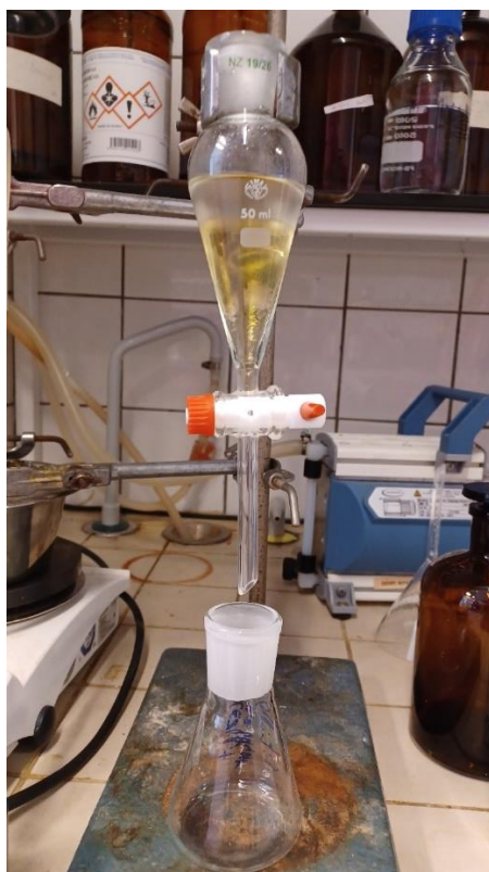
Obrázek 23 Extrakce kapalina-kapalina vodné okyselené fáze s EtOAc (vrchní vrstva).
