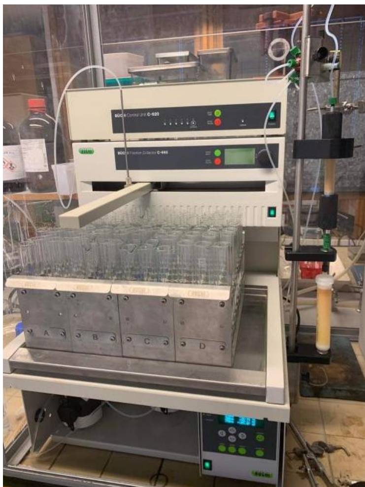
Obrázek 32 chromatograf s Flash systémem Sepacore Control 1.0
