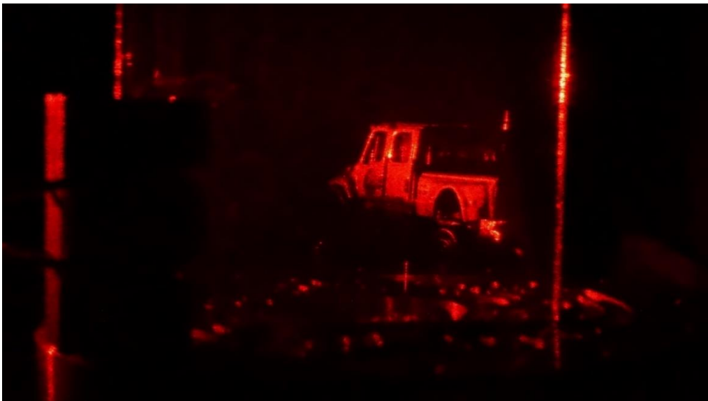
Obrázek 37: Rekonstruovaný transmisní hologram scény s modelem auta (autor, 2023)
