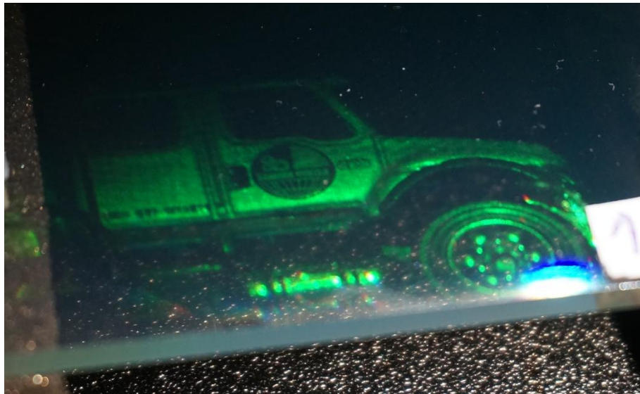
Obrázek 39: Rekonstruovaný reflexní hologram scény s modelem auta (autor, 2023)
