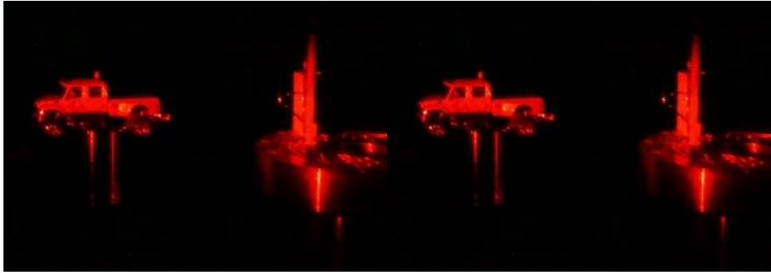
Obrázek 36: Záznam transmisního hologramu. Vlevo auto, vpravo skupina figurek. Deska s mincemi slouží k nastavení geometrie (autor, 2023)
