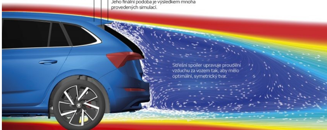
Obrázek 13: Úpravy karoserie ŠKODA SCALA pro snížení součinitele odporu vzduchu [14]
