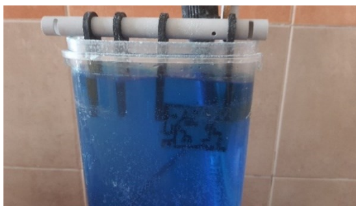
Obr. 18 Leptání v chloridu železitém
