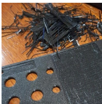
Obr. 6 Odstranění podpěr z druhé vrstvy
