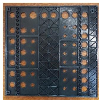
Obr. 7 Žebrování na spodní straně druhé vrstvy, zajišťuje zpevnění modelu
