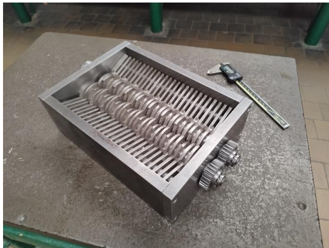
Obr. 2: Obráběné drtící ústrojí z oceli
