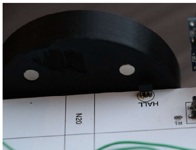
Obrázek 13: Hallova sonda vedle kola s magnety
