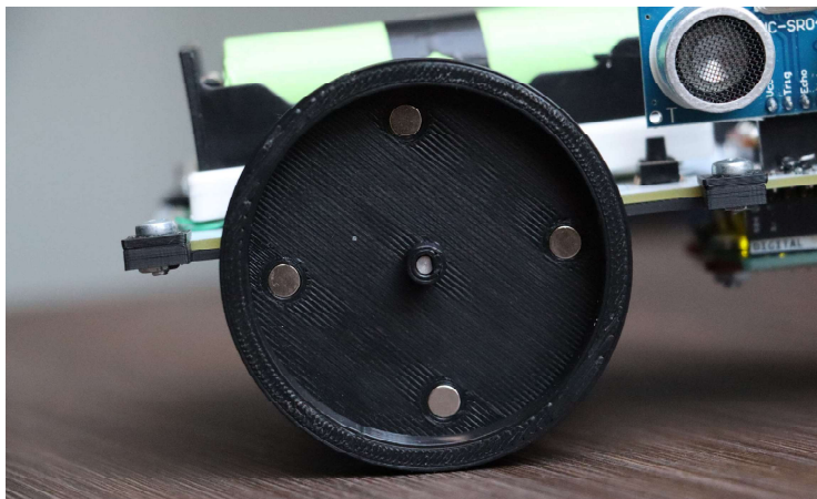
Obrázek 14: Kolo s magnety z pravé strany (bez pneumatiky)
