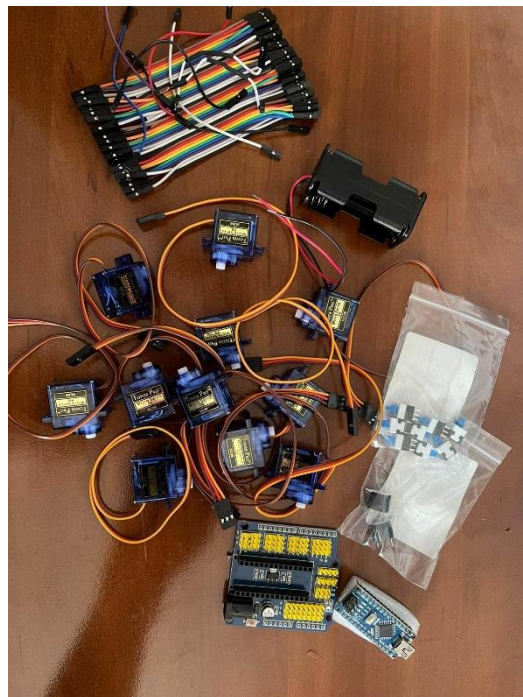
Obr. 14: Elektronické součásti pro „pavoučka“
