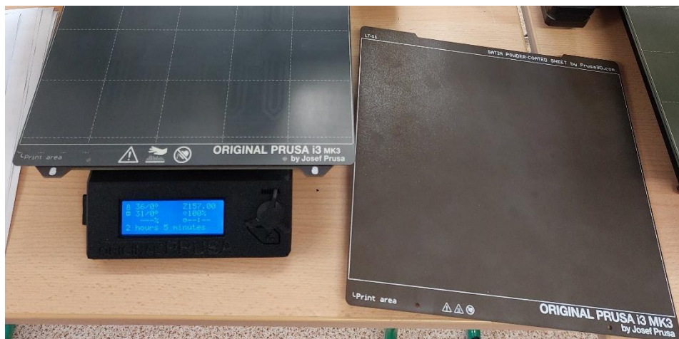
Obr. 7: Vyměnitelný tiskový plát pro tiskárnu MK3S+
