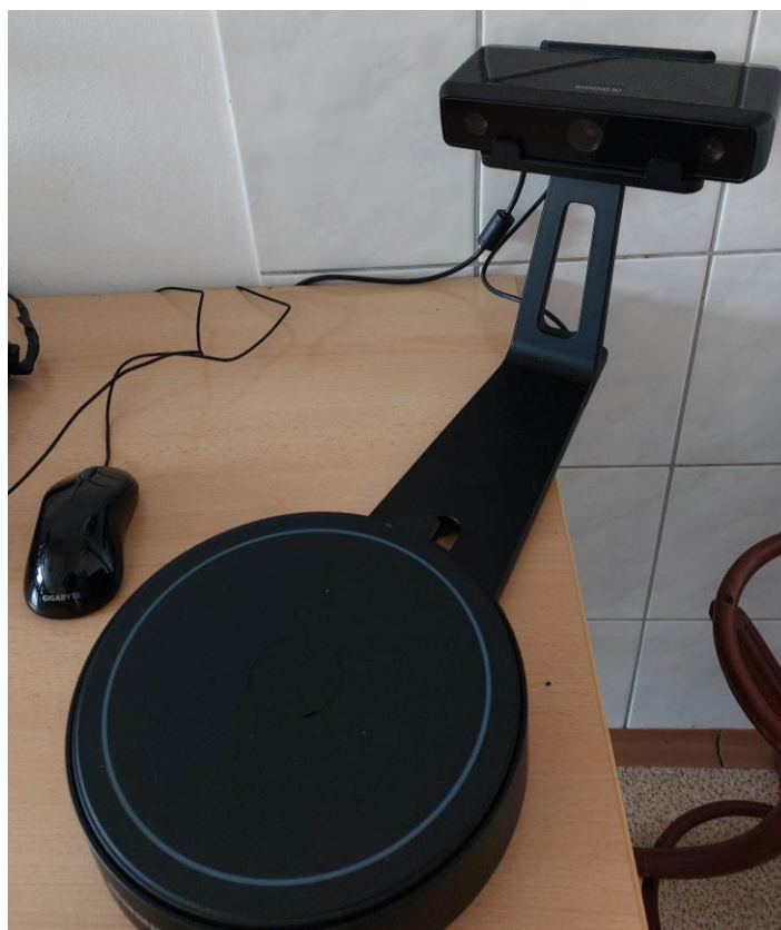
Obr. 2: 3D skener EinScan SE s otočným stolem
