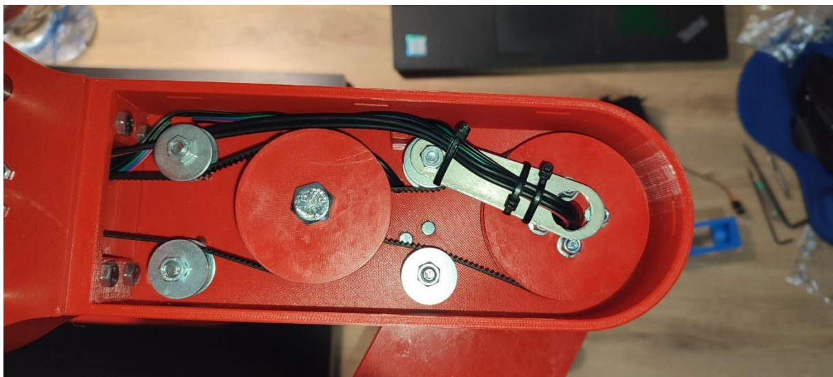
Obrázek 12- Vedení vodičů, pomocný držák.
