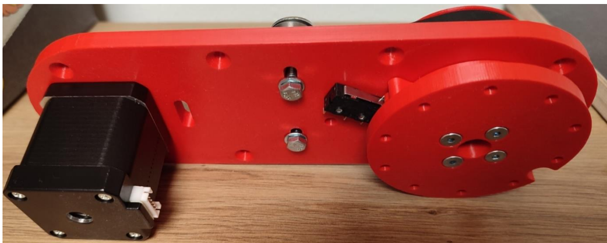
Obrázek 7- Krokový motor třetího kloubu
