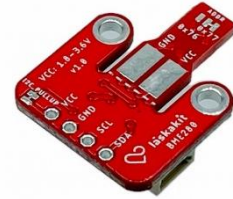
Obr. 45: BME280 je senzor pro měření teploty, tlaku a vlhkosti v okolí pozemní stanice
