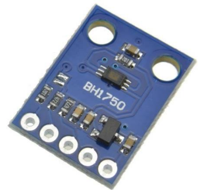
Obr. 29: BH1750 je senzor pro snímání intenzitu dopadajícího světla
