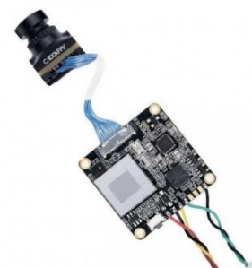
Obr. 36: Caddx Loris 4K je kamera pro natáčení obrazu při letu
