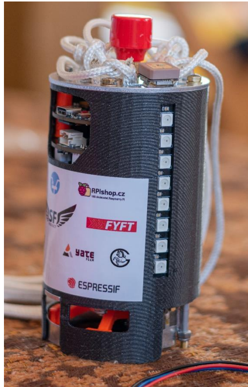
Obr. 1: CanSat je satelit o velikosti plechovky měřící okolní veličiny, které následně vysílá na zem
