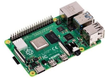
Obr. 40: Raspberry PI 4B řídí veškeré procesy v pozemní stanice
