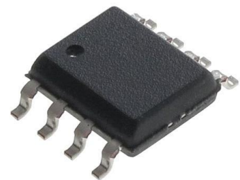
Obr. 24: MAX1626 je step-down obvod snižující napětovou úroveň
