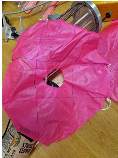
Obr. 52: Padák se využívá ke kontrole pádu satelitu
