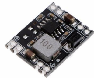
Obr. 47: SMD step-down modul mění napěťovou úroveň pro senzory
