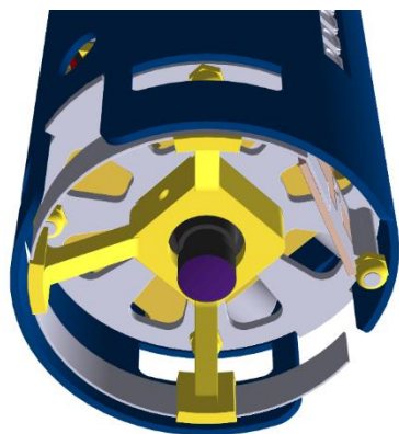
Obr. 31: Invertovaná F-anténa CanSatu pro vysílání na 433 MHz
