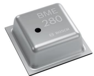
Obr. 19: BME280 je senzor pro měření teploty, tlaku a vlhkosti ve svém okolí
