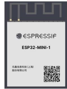
Obr. 18: ESP32-MINI-1 je mikrokontroler řídící chod CanSatu
