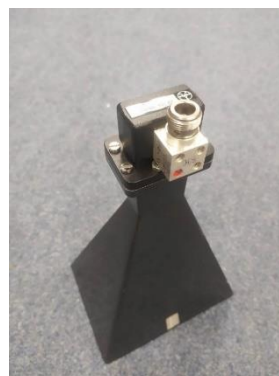
Obr. 32: Směrová anténa sloužící pro příjem videa z CanSatu
