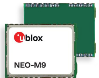
Obr. 13: NEO-M9N je GNSS modul pro zjištění polohy CanSatu
