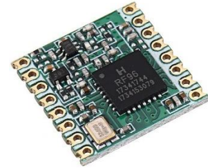
Obr. 41: RFM96W je LoRa modul pro přijímání dat z CanSatu
