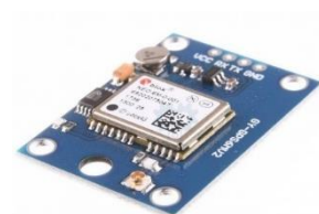
Obr. 44: GY-NEO6MV2 je modul pro zjišťování polohy pozemní stanice
