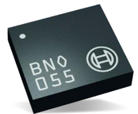
Obr. 12: BNO055 je senzor měřící náklon a zrychlení
