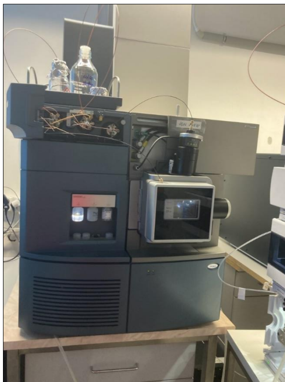
Obrázek 9: Hmotnostní spektrometr Xevo G2-XS QTOF (Waters Milford MA, USA)
