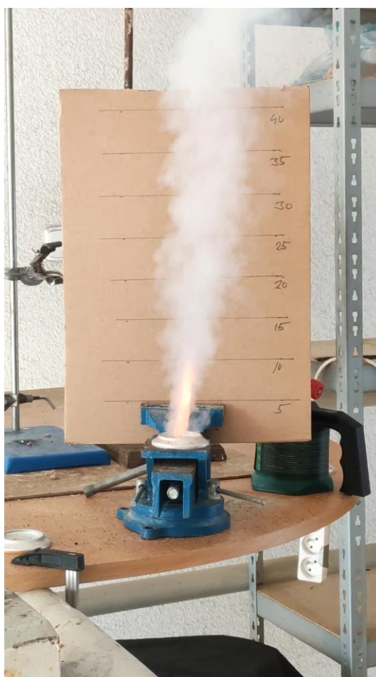
Obr. 21: Testování vzorku \text{Bi}_2\text{O}_3 s kartonovou deskou (4. experiment)
