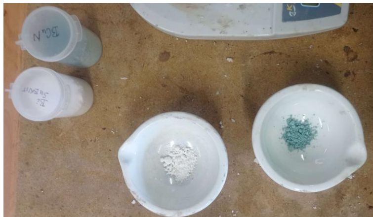
Obr. 36: Moderátory připravené v třecích miskách na drcení
