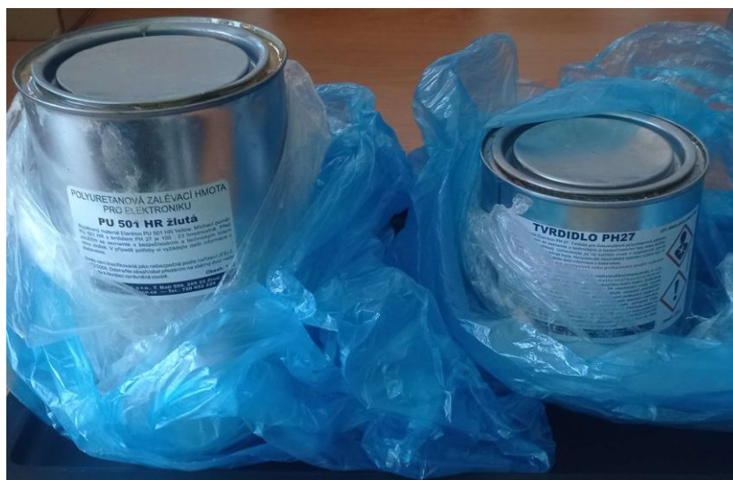
Obr. 55: Použité hmoty pro zavíčkování motoru – PU a polykyanát (tvrdidlo)
