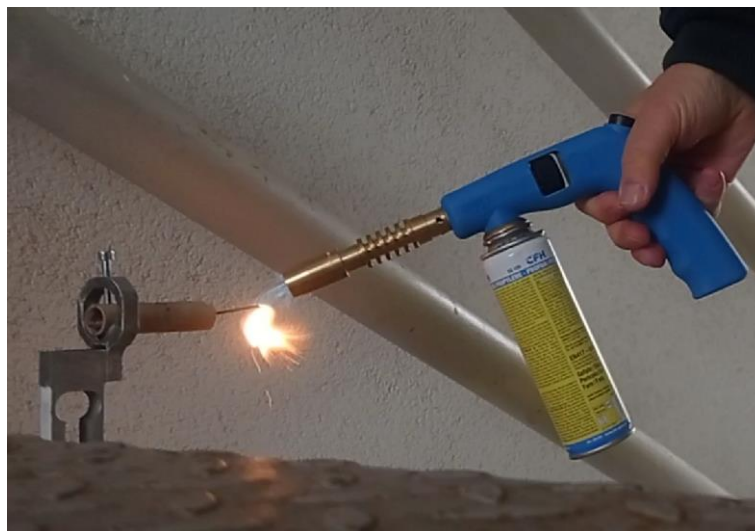
Obr. 64: Zapalování motoru s moderátorem BiSubN, metoda tavení TPH v dutince, pořadové číslo 3
