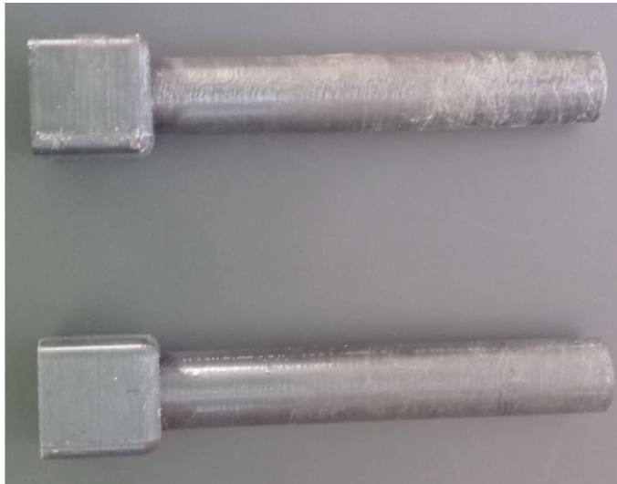
Obr. 48: 3D vytištěné písty
