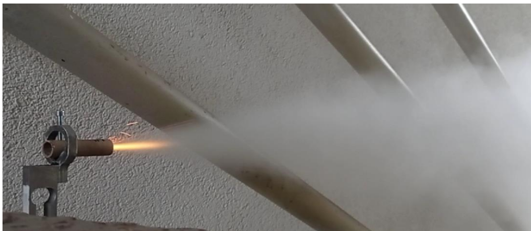
Obr. 65: Plamen motoru s propelentem SX-81, metoda tavení TPH v dutince, pořadové číslo 1
