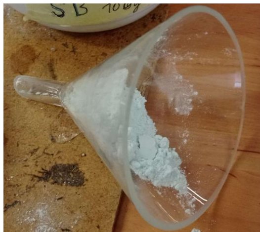
Obr. 51: Násypka pro dávkování práškového propelentu BCuN
