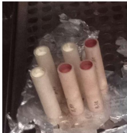
Obr. 53: Dutinky v sušárně s práškovým KNSB + Fe 2 O 3 a SX-81 připraveným na tavení
