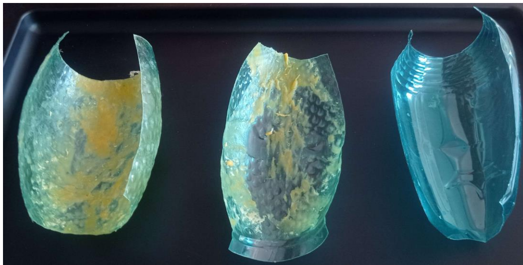
Obr. 54: Mističky ve tvaru lodiček k odlévání polyuretanu do motorů
