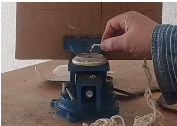
Obr. 24: Zapalování vzorku \text{Fe}_2\text{O}_3 2 % pomocí doutnáku (5. experiment)
