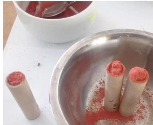
Obr. 50: Práškový propelent KNSB s BCuN nalevo a Fe 2 O 3 napravo
