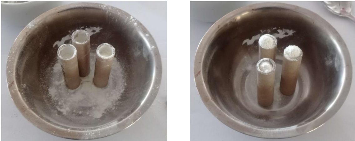
Obr. 52: Práškový KNSB s BiSubN – 1. upěchovaná vrstva nalevo a 2. vrstva nasypaná k upěchování napravo
