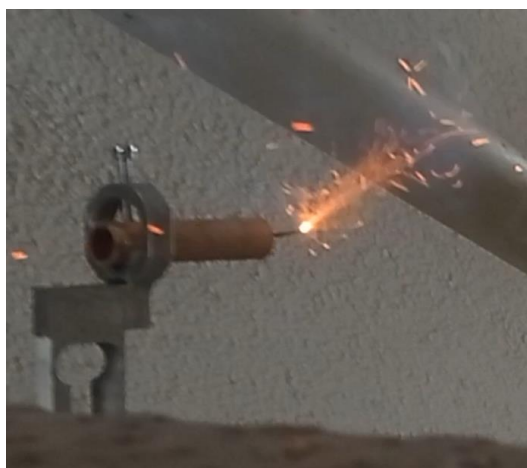
Obr. 66: Zapálená zápalnice u motoru s moderátorem \text{Fe}_2\text{O}_3 , metoda tavení TPH v dutince, pořadové číslo 3
