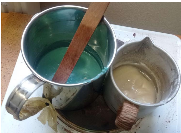
Obr. 44: Ztekucený propelent s přidáním SLESem (KNSB + BCuN/BiSubN)
