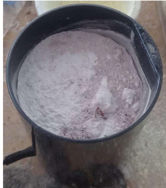
Obr. 46: Práškové formy KNSB v mlýnku před mletím (BCuN nalevo a Fe 2 O 3 napravo)
