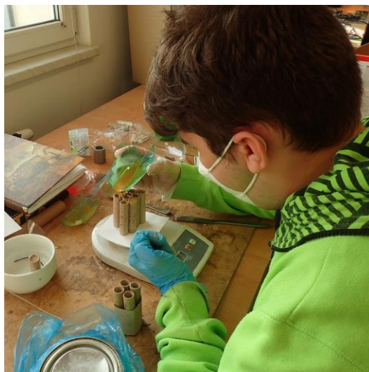
Obr. 56: Lití polyuretanu do motorů = „víčkování“
