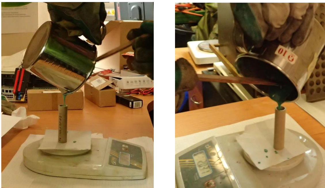
Obr. 45: Lití propelentu KNSB s BCuN do dutinky
