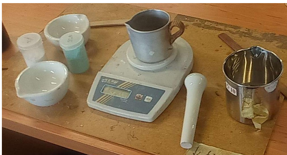
Obr. 38: Vážení složek propelentů (kompozice s moderátory BiSubN a BCuN)
