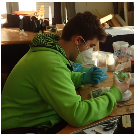
Obr. 56: Lití polyuretanu do motorů = „víčkování“
