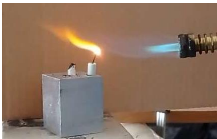
Obr. 25: Zapalování vzorku \text{BCuN} plynovým hořákem (2. experiment)
