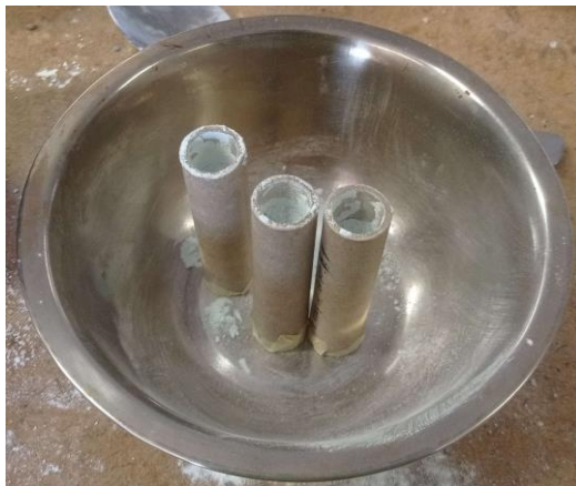
Obr. 50: Práškový propelent KNSB s BCuN nalevo a Fe 2 O 3 napravo
