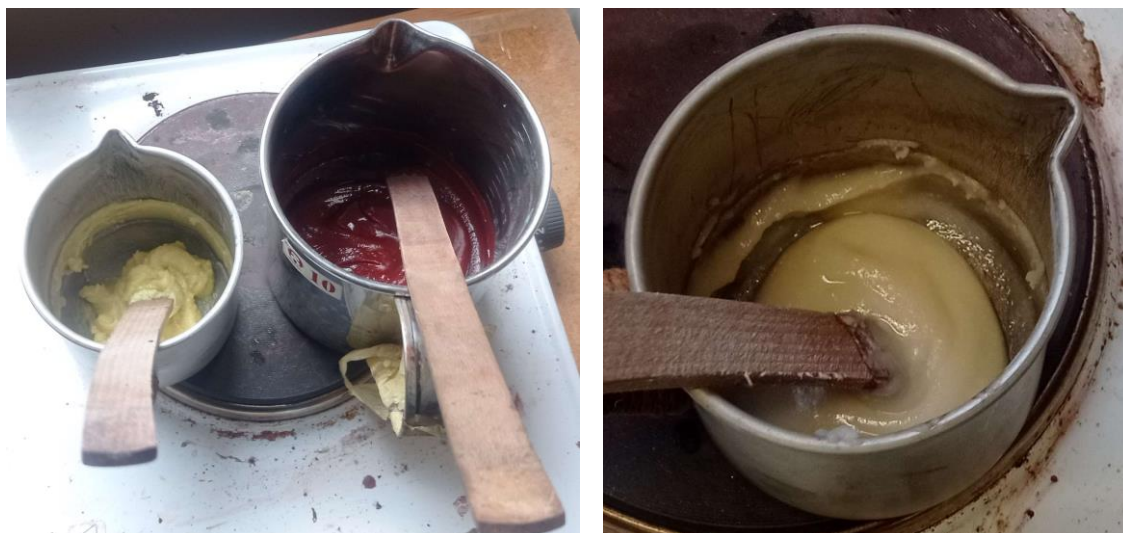
Obr. 40: Roztavené kompozice KNSB (nalevo SX-81 a KNSB + Fe 2 O 3 , napravo KNSB + BiSubN)
