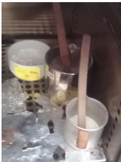
Obr. 39 Propelenty SX-81 a KNSB + Fe 2 O 3 v sušárně připravené k tavení
